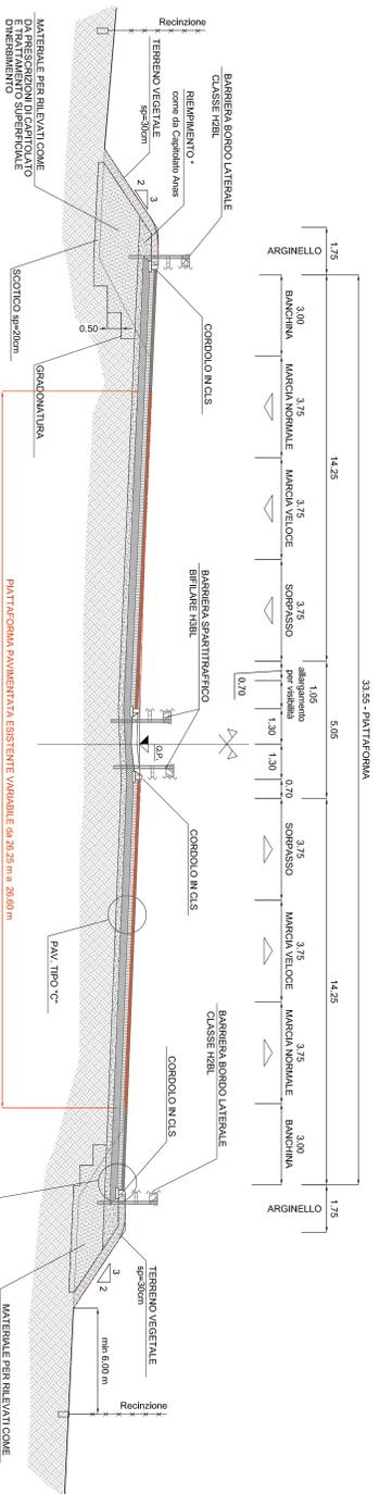
SEZIONE TIPO AUTOSTRADA A26 - INTERVENTO DI PROGETTO (COMPATIBILE CON AMPLIAMENTO ALLA 3ª CORSA)
