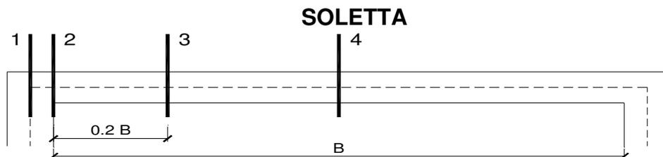
Figura 13 - Sezioni verificate sulla soletta superiore
