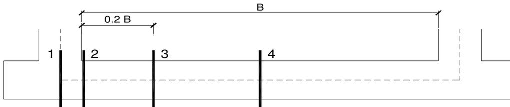
Figura 26 - Sezioni verificate sulla soletta inferiore
