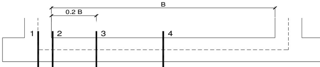
**Figura 19 - Sezioni verificate sulla soletta inferiore**
