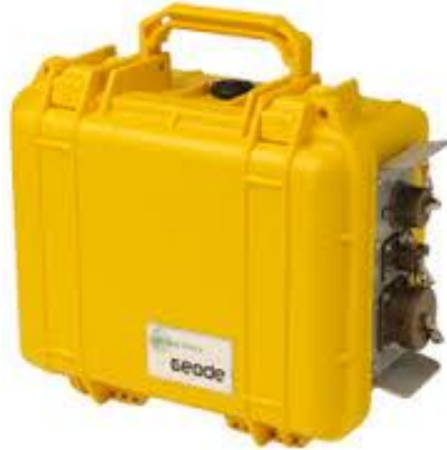
Figura 6 - Sismografo GEODE (Geometrics)
