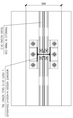
PARTICOLARE ASSONOMETRICO PANNELLO IN PMMA
