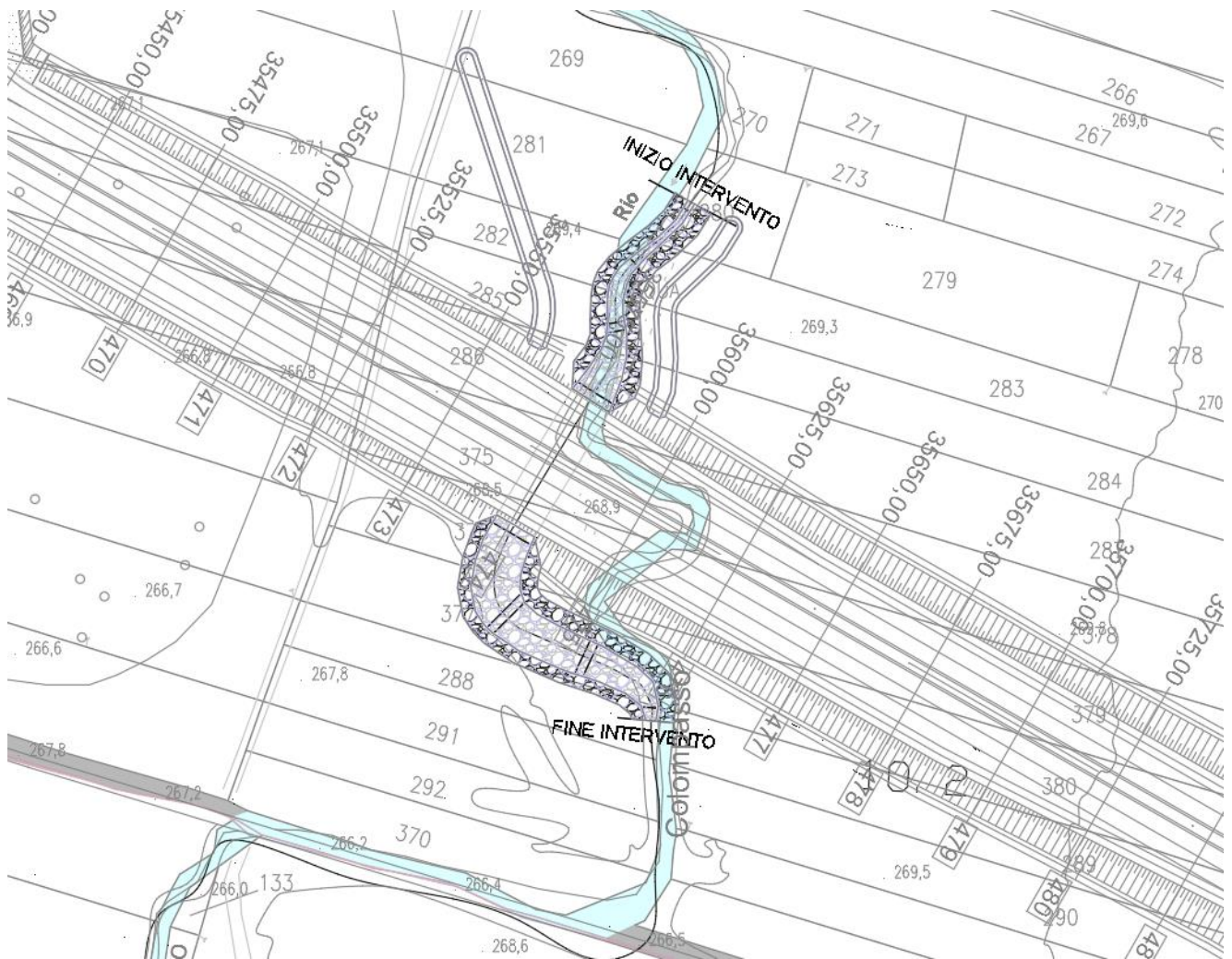
Figura 68 - - Planimetria della deviazione per il Rio Colompasso
