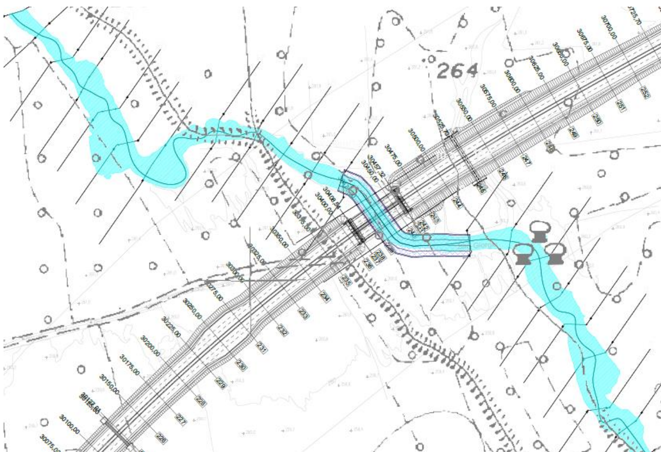
Figura 19 - Impronta idrica dell'area di esondazione della Riale San Girogio per Q ( T=200 ) nella configurazione di progetto
