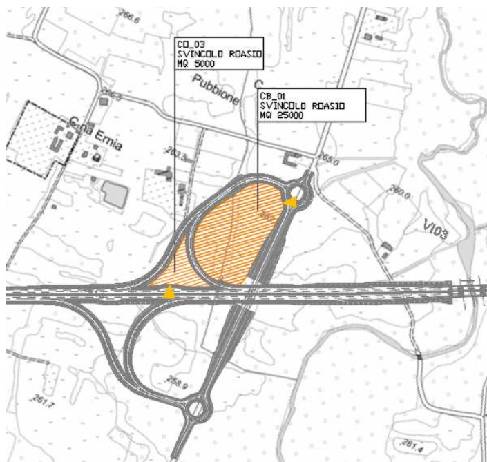
Figura 2-6 Aree di cantiere ubicate nei pressi del nuovo svincolo di Roasio
