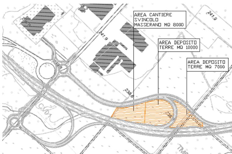
Figura 6-1 Area di cantiere e di deposito ubicati nei pressi del nuovo svincolo di Masserano
