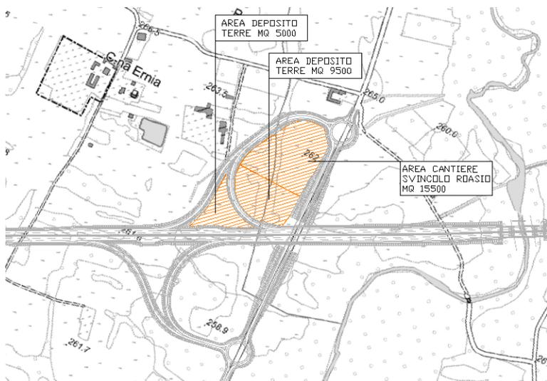
Figura 6-2 Area di cantiere e di deposito ubicati nei pressi del nuovo svincolo di Roasio
