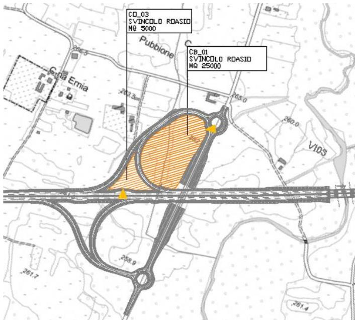
Figura 7-2 Aree di cantiere ubicate nei pressi del nuovo svincolo di Roasio
