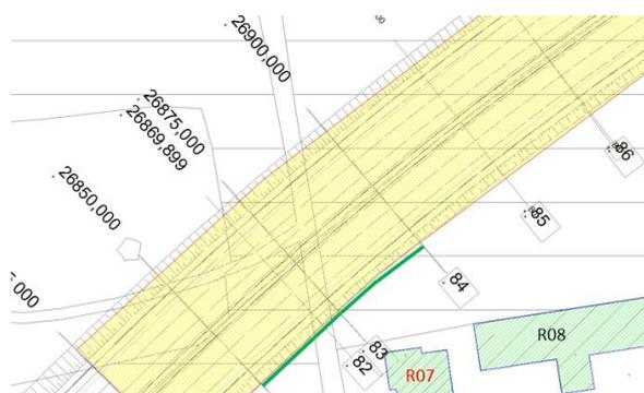
Figura 6-7 Dettaglio planimetrico per i ricettori con livello acustico oltre il limite normativo e inserimento della barriera acustica mobile
