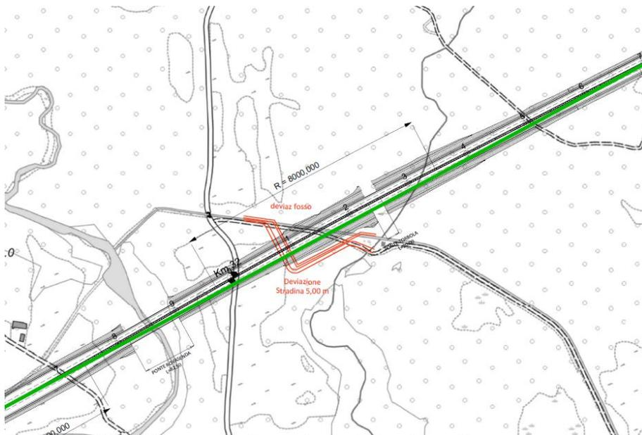
Figura 3-7 Variante planimetrica necessaria alla deviazione del fosso e della strada poderale (in rosso). In verde è riportato il tracciato stradale in progetto superato
