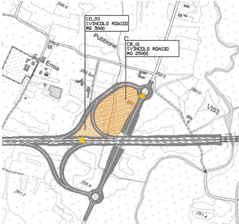
Figura 6-3 Ubicazione cantiere operativo CO\_03 a servizio dello svincolo di Roasio
