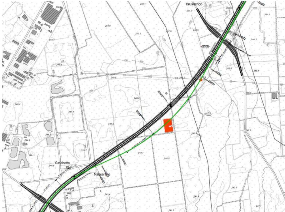
Figura 3-6 Variante planimetrica in presenza del bacino d'acqua e del traliccio (in rosso). In verde è riportato il tracciato stradale in progetto superato
