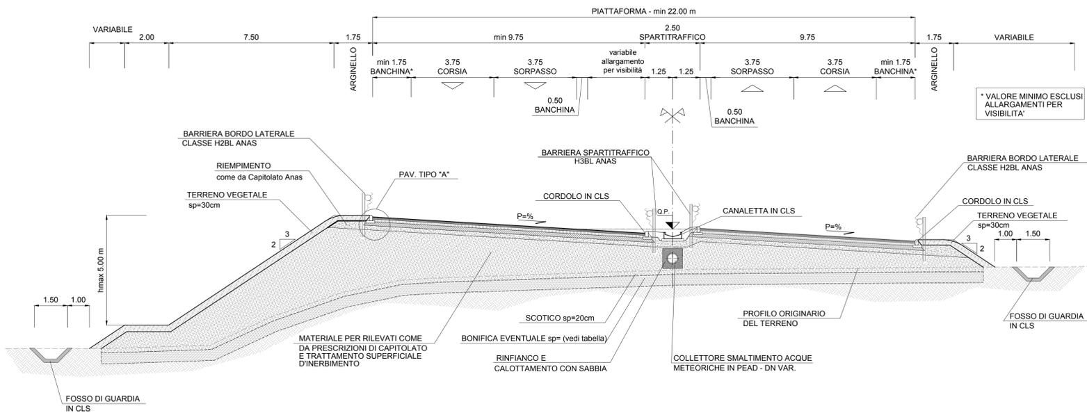
SEZIONE TIPO RAMPE MONODIREZIONALI
