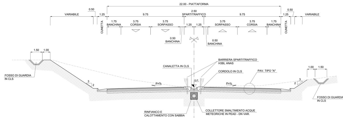
SEZIONE TIPO PEDEMONTANA - cat. "B" DM 6792
