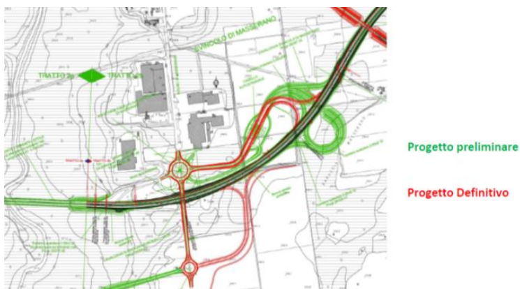
Figura 3-10 Rappresentazione ottimizzazione configurazione Svincolo di Masserano
