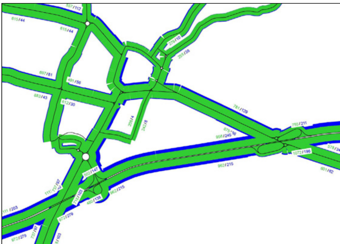
Img. 4.6 - Flussi di traffico nello scenario futuro Intermedio, ora di punta della mattina tra le 8 e le 9
