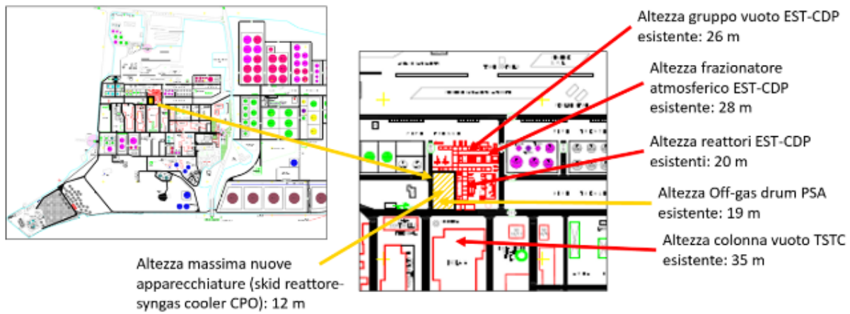
Figura 51: identificazione degli ingombri delle installazioni che circondano l'area di ubicazione dell'impianto CPO – Demo
