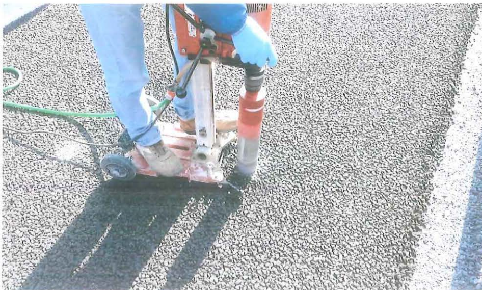
Fig. 5.4 – Prelievo di carote dal campo prove
