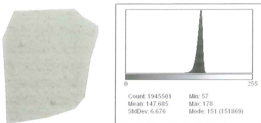
Fig. 4.7 – Campione 6 A e relativo istogramma, 26 giorni di esposizione, analisi viraggio
