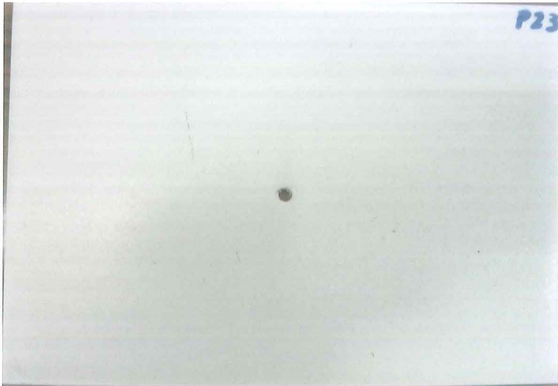
Fig. 3.3 – Immagine del campione P23. Tunnel Sud, pannello basso, 14 giorni di esposizione, supporto PVC, pitturato in laboratorio
