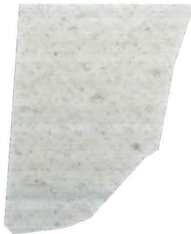
Fig. 4.16 – Campione 3 B, 26 giorni di esposizione, analisi viraggio
