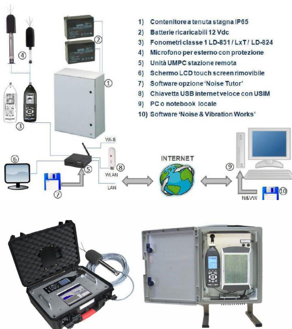
FIGURA 8-3 COMPONENTI SISTEMI DI MONITORAGGIO
