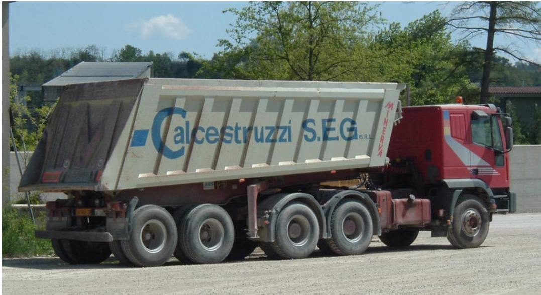
Abbildung 3.2. Abbildung eines Sattelkraftfahrzeugs mit 4 Achsen für Baustellenarbeiten.
