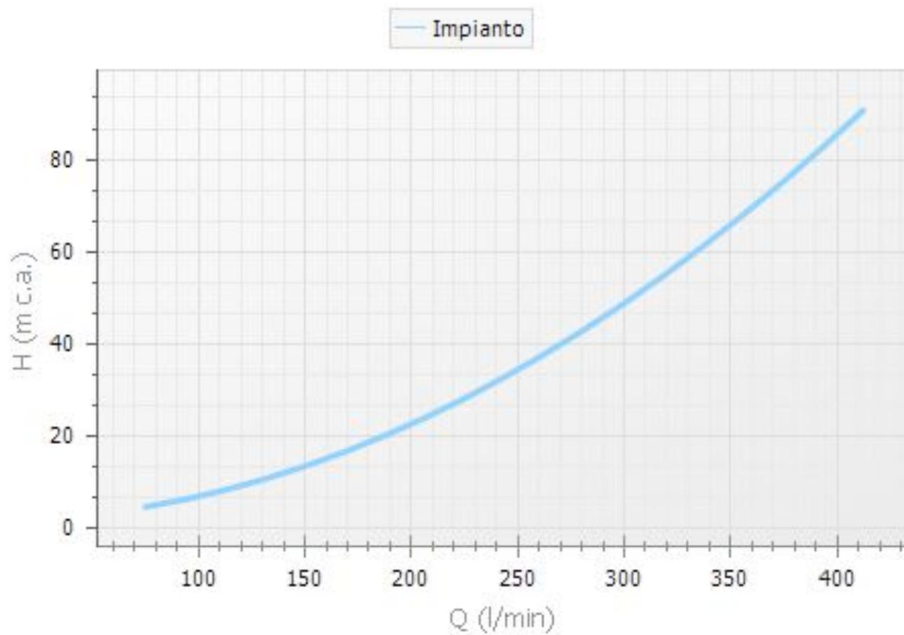
Fig. 1: Caratteristica  $H(Q)$  dell'impianto
