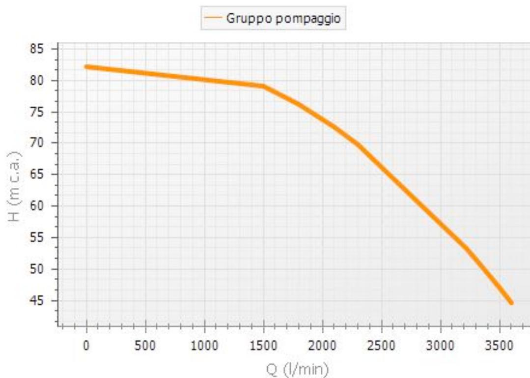
Fig. 2: Caratteristica H(Q) del gruppo di pompaggio
