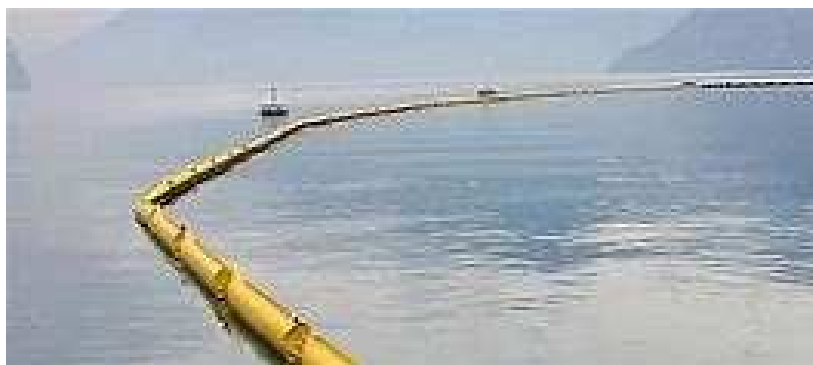
Fig.44- Perimetrazione con panne galleggianti anti inquinamento
