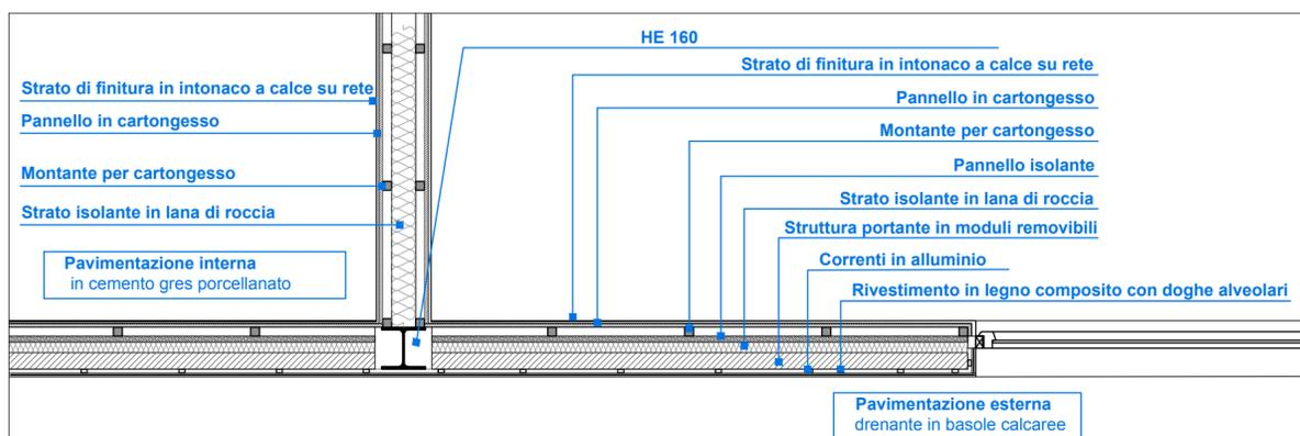
Centro Servizi - pianta dettaglio costruttivo
