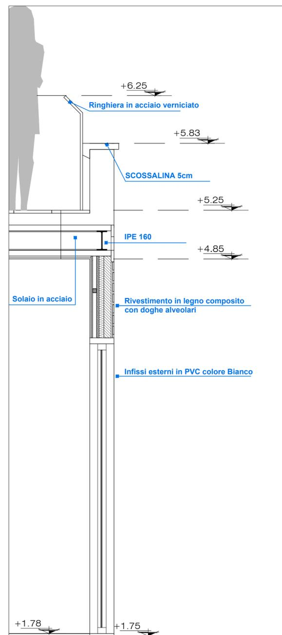
Centro Servizi - sezione dettaglio costruttivo
