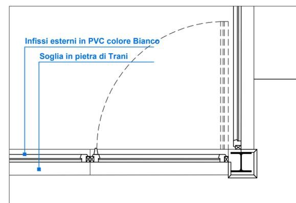
Centro Servizi - pianta dettaglio costruttivo
