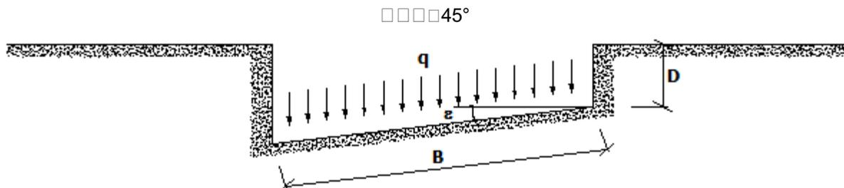
**Calcolo dei fattori di riduzione per rottura a punzonamento  $\alpha_c, \alpha_q, \alpha_\sigma$**
