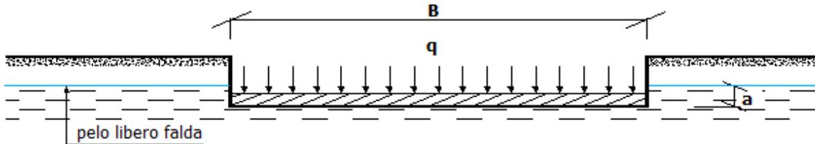
Se il pelo libero della falda è al di sotto del piano di posa della fondazione di una profondità  $d$ , tale che:
