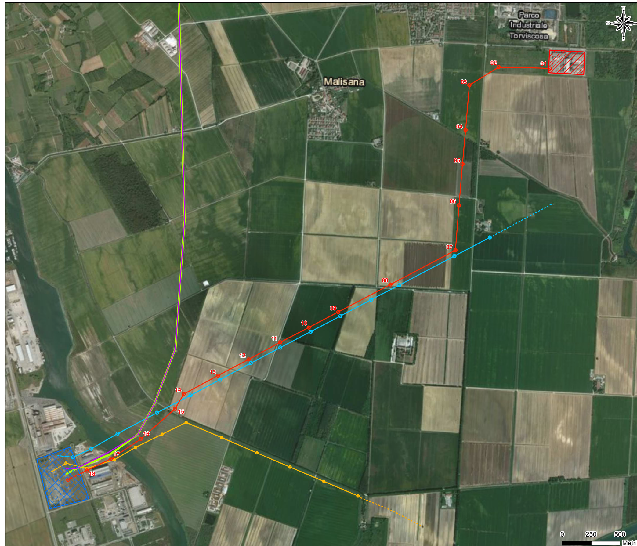
Figura 3a Planimetria delle opere di connessione alla RTN della Centrale di Torviscosa
