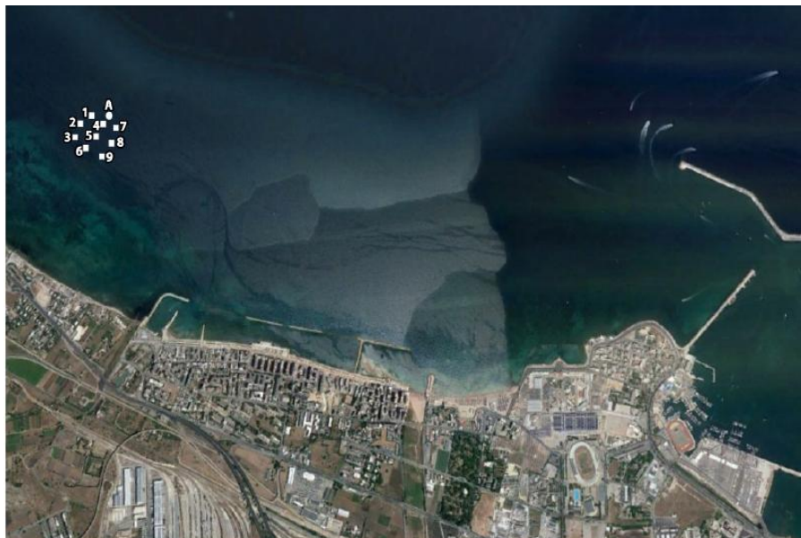
Fig. 2.1.1.A – Allocazione delle 9 stazioni di conta fasci (quadrati bianchi 1-9, ognuna replicata 10 volte nell'intorno del punto georeferenziato), in corrispondenza del sistema di balisage a Nord del porto di Bari. I cerchi bianchi indicano il sistema di balisage impiantato ( balisage A, n. 7 paletti).
