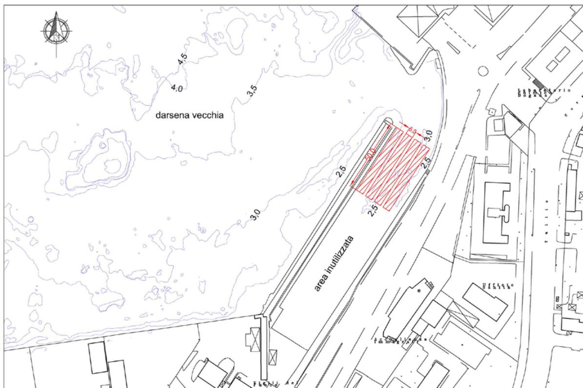
Fig.13 – Particolare collocazione geotubi in un'area inutilizzata - darsena Vecchia
