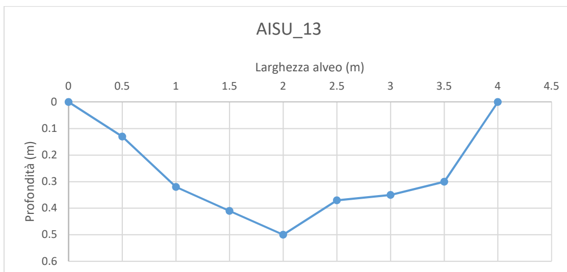
Figura 3.4 -- Stazione AISU_13 Fiumara Torbido – profilo della sezione di misura
