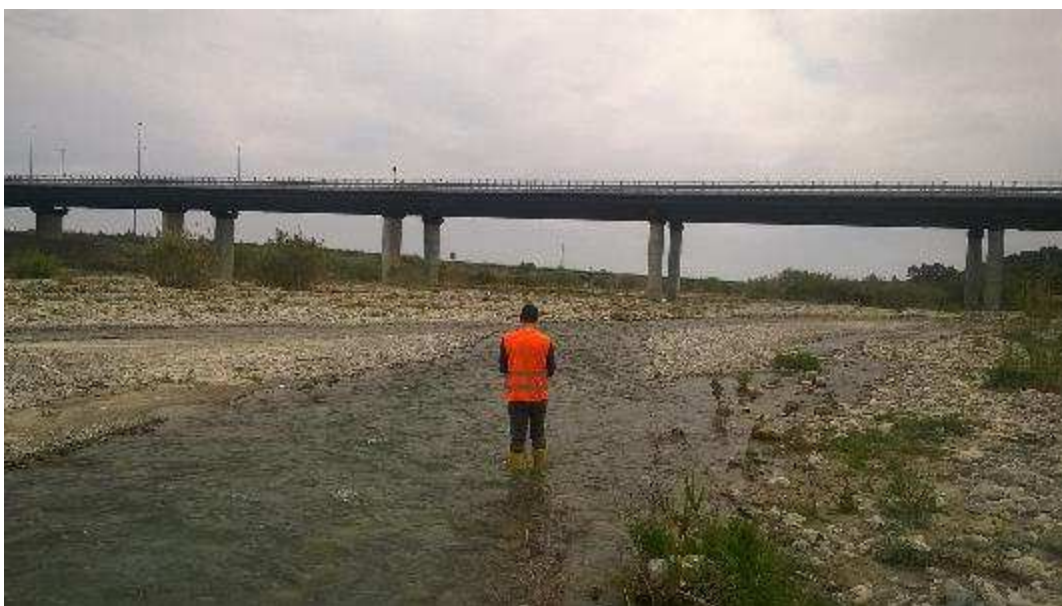
Foto 3 – Misura di portata sulla Fiumara Torbido nella stazione AISU_14
