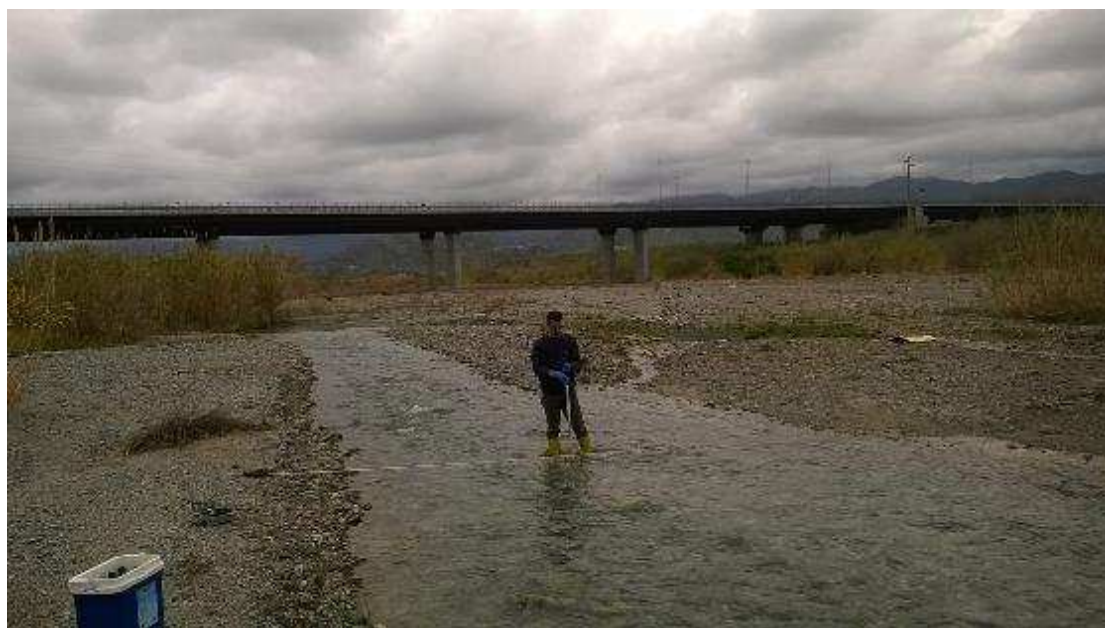
Foto 2 – Misura di portata sulla Fiumara Torbido nella stazione AISU_13
