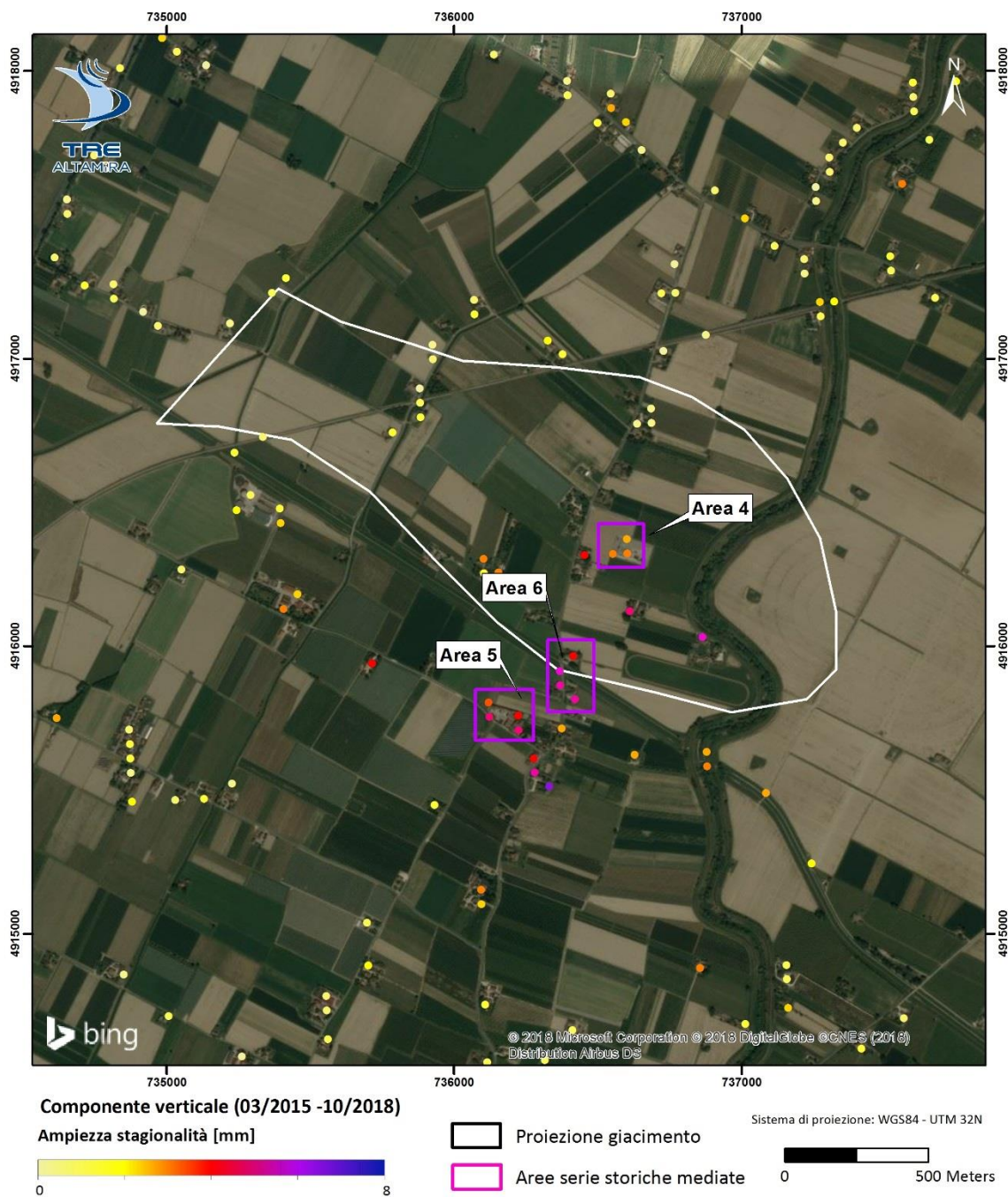
Figura 18: Dettaglio della stagionalità media per la componente verticale nell'area del Cluster B di Cotignola
