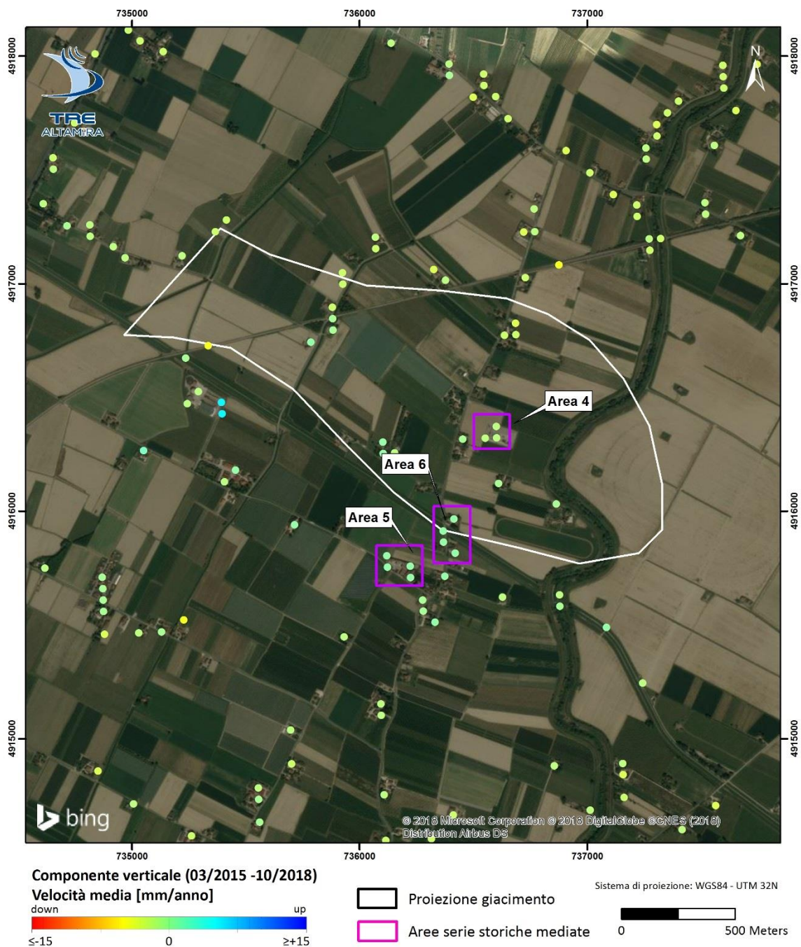
Figura 17: Dettaglio della componente verticale nell'area del Pool B. Le serie storiche dei punti all'interno delle aree viola sono stati mediate per ottenere le serie storiche medie mostrate in Figura 19
