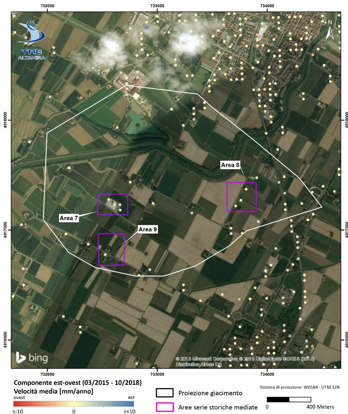
Figura 25: Dettaglio dei risultati della componente orizzontale est-ovest (velocità media) sull'area del Pool C. La serie storica media dei punti compresi nell'area 7 è mostrata in Figura 27.
