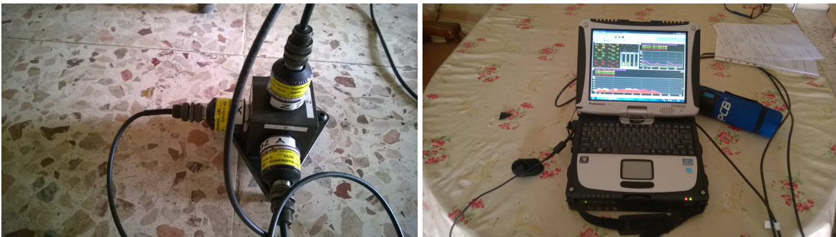
Figura 9 – Monitor del Soundbook e sensori della terna accelerometrica
