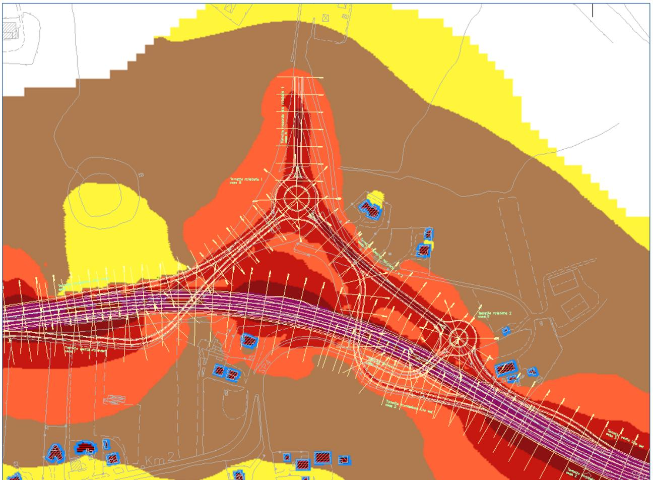
Figura 8 - Dettaglio di Mappatura Acustica evidenziante l'effetto delle barriere
