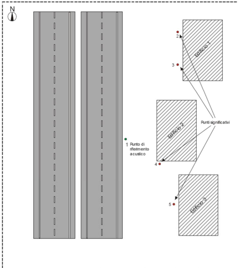
Figura 5 - Distribuzione punti di misura spot rispetto al punto di misura settimanale.
