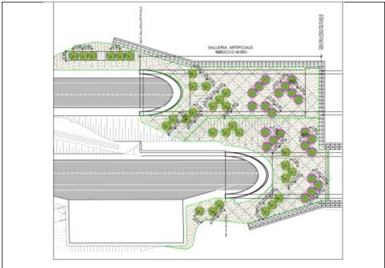
Figura 35: Pianta tipo per imbocco galleria artificiale
