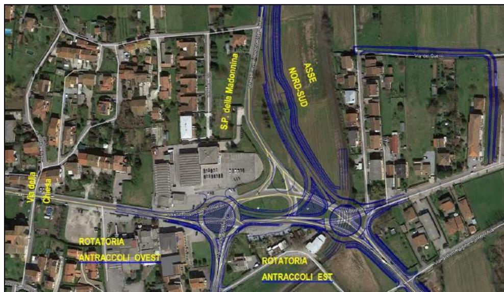
*Configurazione a due rotatorie della nuova intersezione di Antraccoli*
