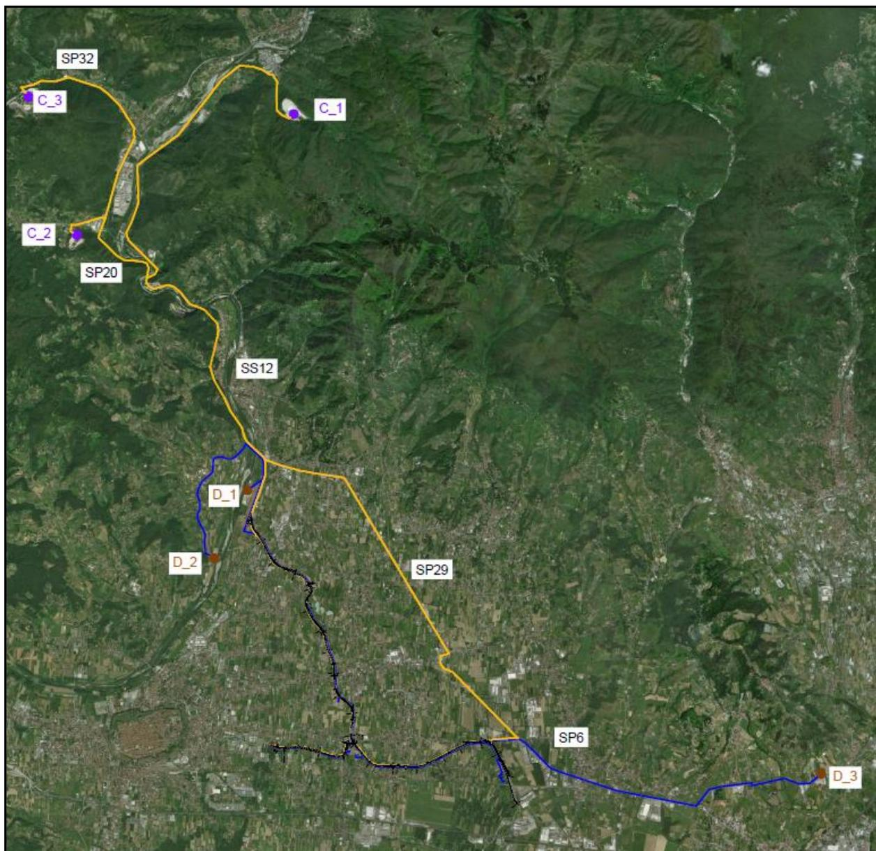
*Viabilità di cantiere impiegate per il raggiungimento dei siti di approvvigionamento (in giallo) e smaltimento (in blu) del materiale*
