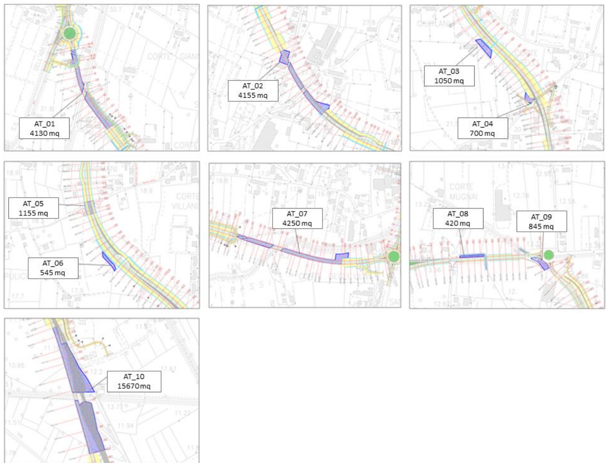
Figura 3-9: Definizione ed estensione delle aree tecniche
