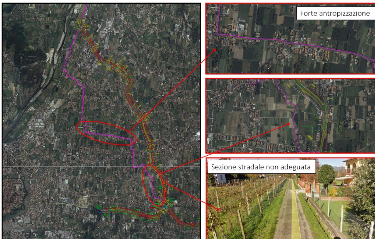
Figura 10-1: Viabilità di cantiere proposta nello SIA
