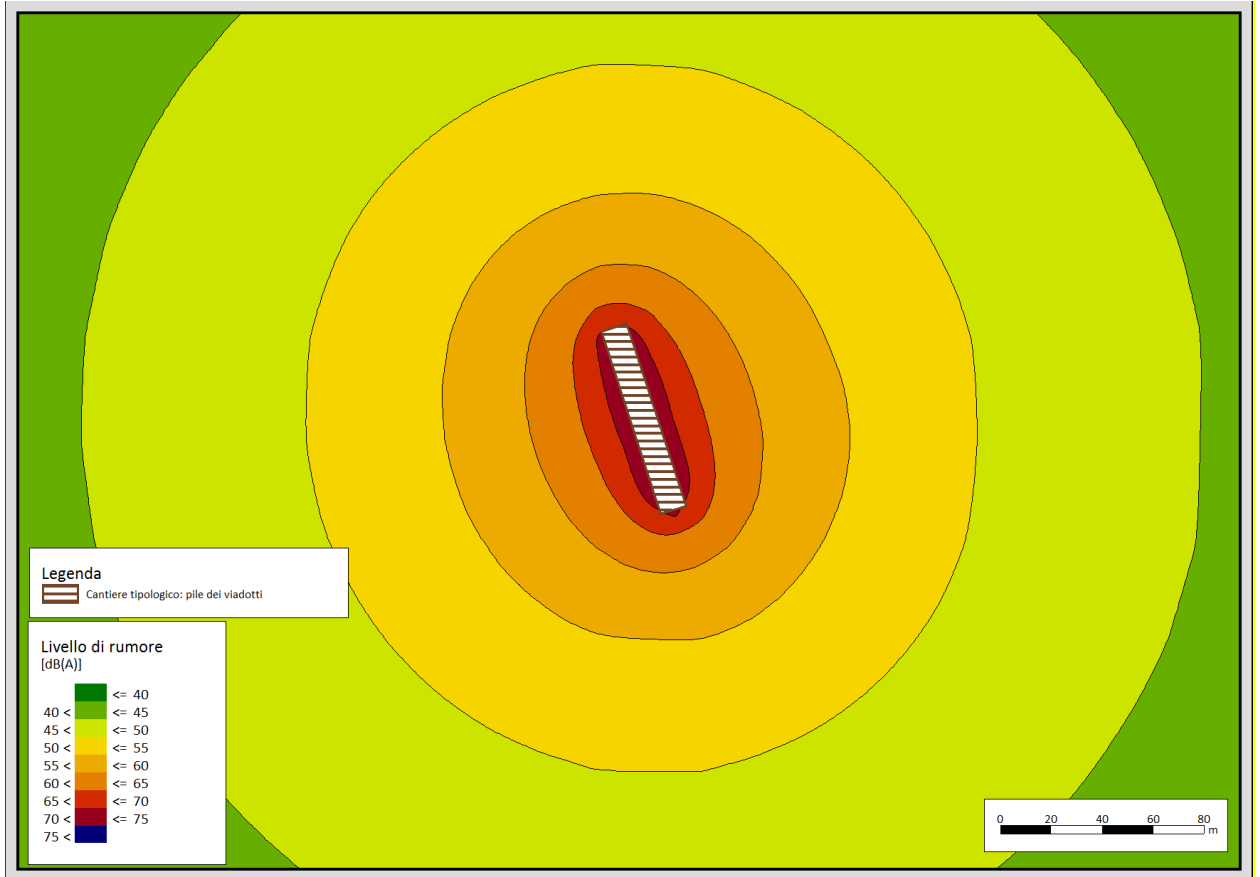
Figura 4-8 Mappatura acustica in planimetria: cantiere mobile connesso alla realizzazione delle pile dei viadotti.
