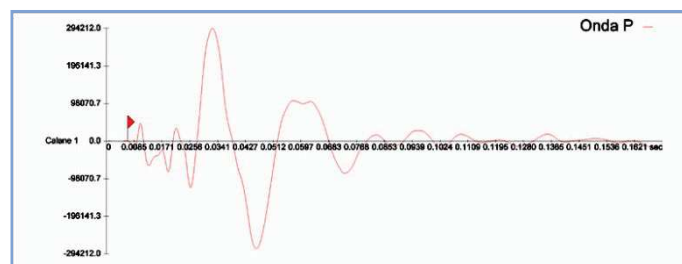
Fig. 3.1.2 - Esempio di onda P e di lettura del primo tempo di arrivo.
