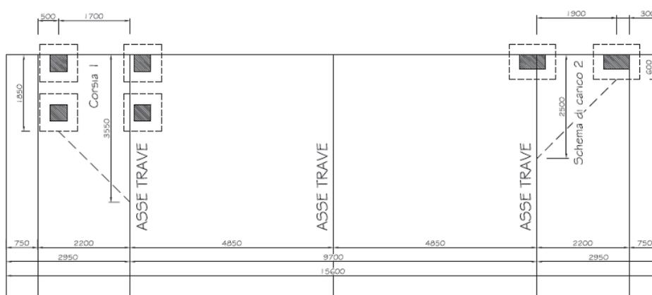
Figura 26: Disposizione carichi da traffico per verifica sbalzo – zona di estremità
