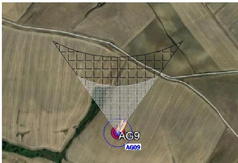
*Figura 21 - Dettaglio dell'ombra di AG9 sulla strada a nord della turbina*
