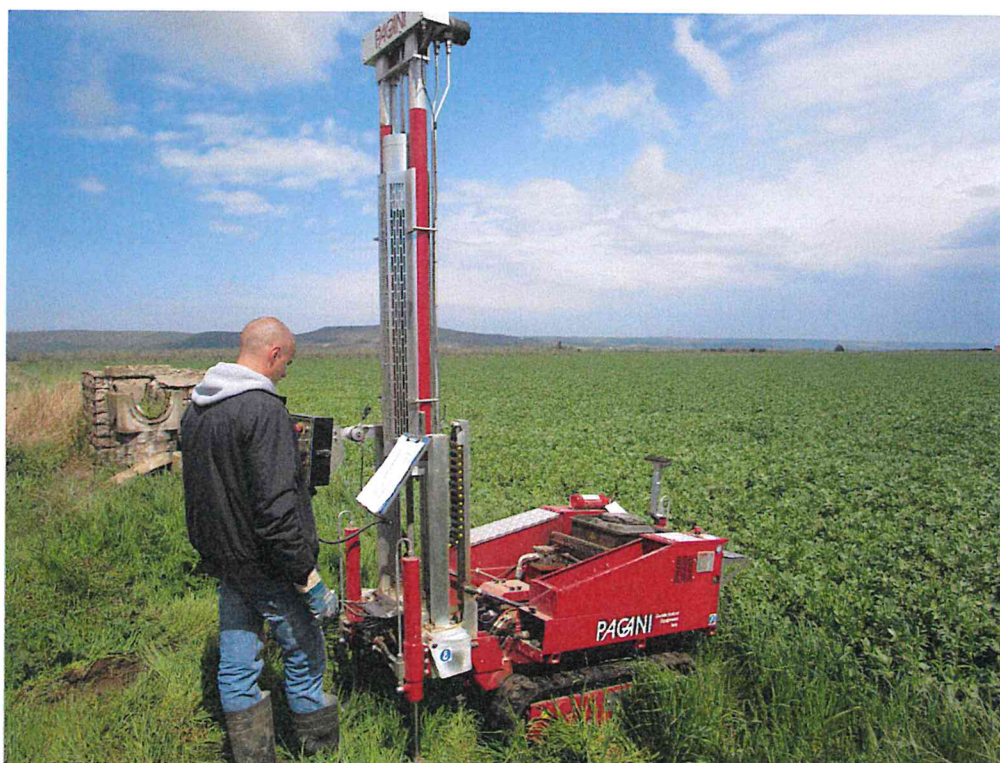
Esecuzione prova penetrometrica spinta fino a 10.0 metri di profondità
