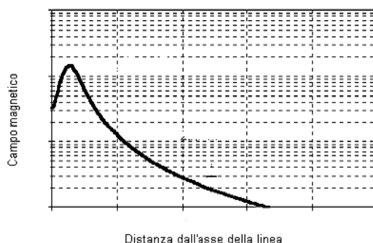
Figura 18: Campo magnetico generato al suolo da un elettrodo interrato
