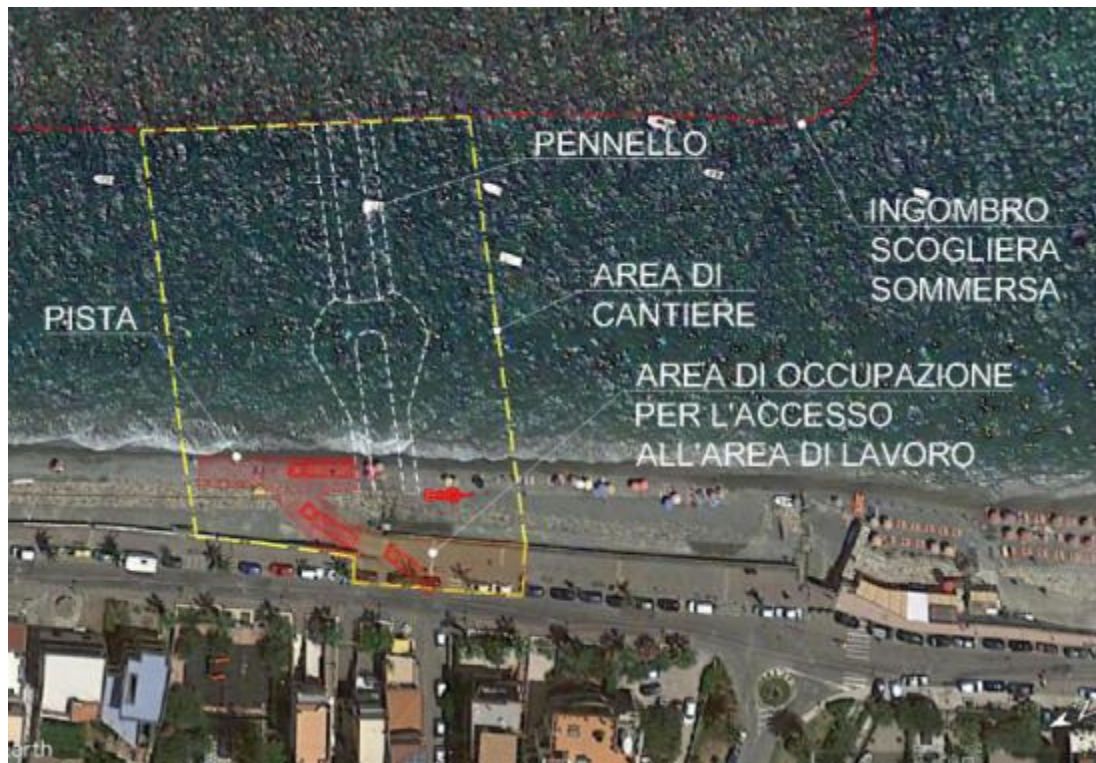
Figura 2 2: Esempio dell'area di cantiere per la costruzione di un pennello
