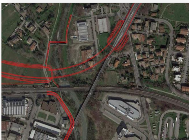
Figura 9.1/5: area di realizzazione dello svincolo: non si segnalano interferenze significative con la vegetazione naturale, le aree alberate intercettate corrispondono a fondi agricoli adibiti ad arboricoltura da legno; le nuove aree intercluse saranno oggetto di una completa sistemazione a verde sia interna che esterna ai rami di svincolo
