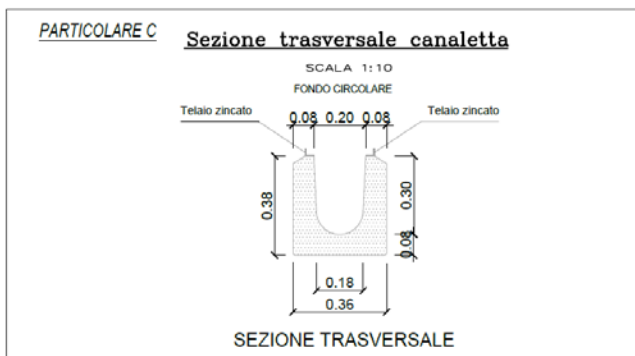
Canaletta 200x300mm adottata per asfalto non drenante
