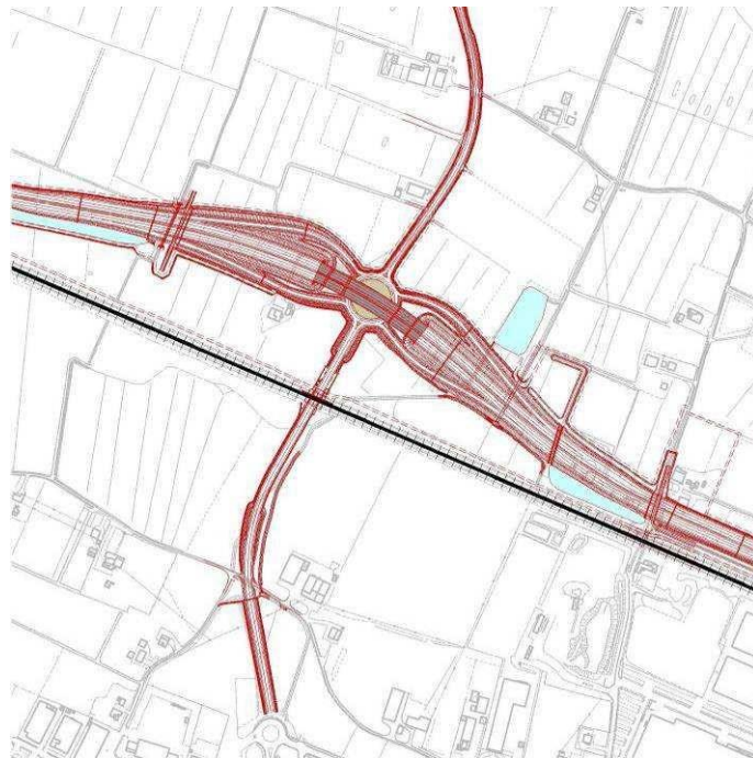
FIGURA 2-3 – CONFIGURAZIONE SVINCOLO “PIEVE MODOLENA”
