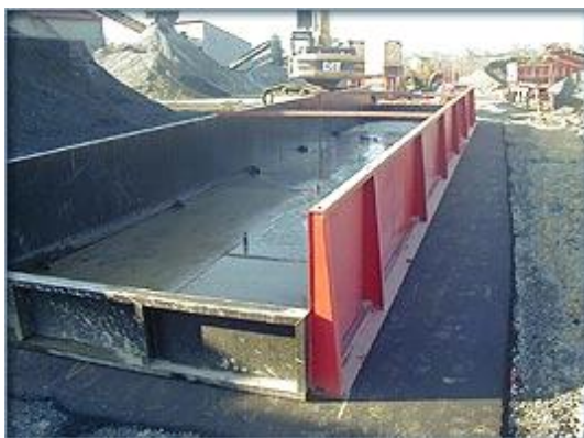
Figura 38 – sistemi di lavaggio dei pneumatici A BACINO.
