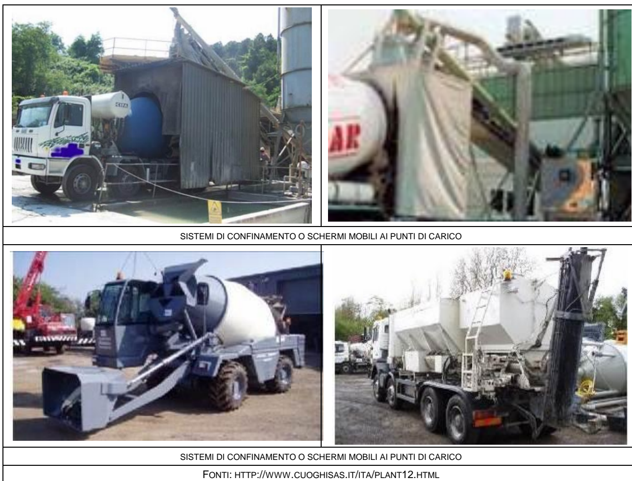
Figura 44 – Soluzioni per mitigazione polveri applicate al punto di carico dei prodotti finali.
