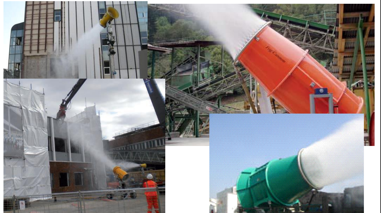
Figura 39 – Sistemi di bagnatura mediante cannoni nebulizzatori.
