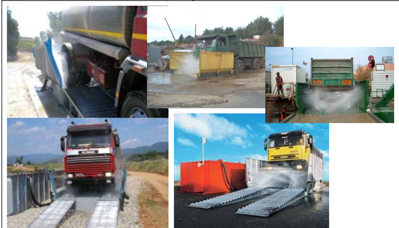
Figura 37– sistemi di lavaggio dei pneumatici A PRESSIONE.
