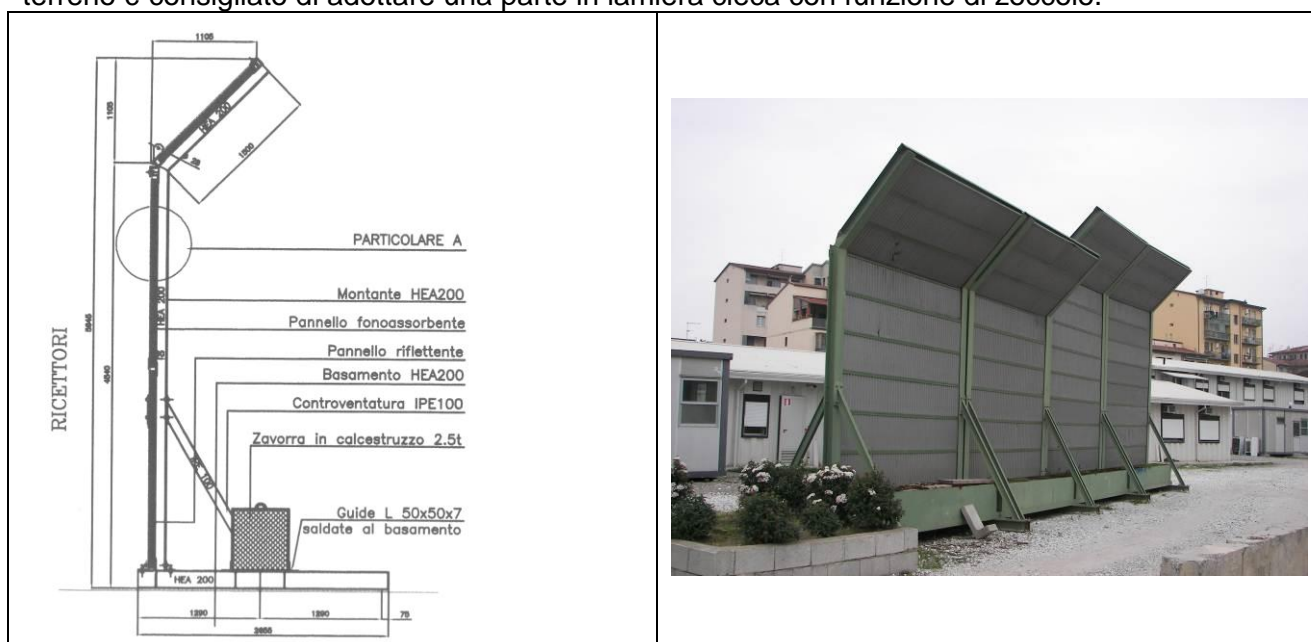
Figura 45 – Soluzioni tipologiche di barriere acustiche di cantiere.
