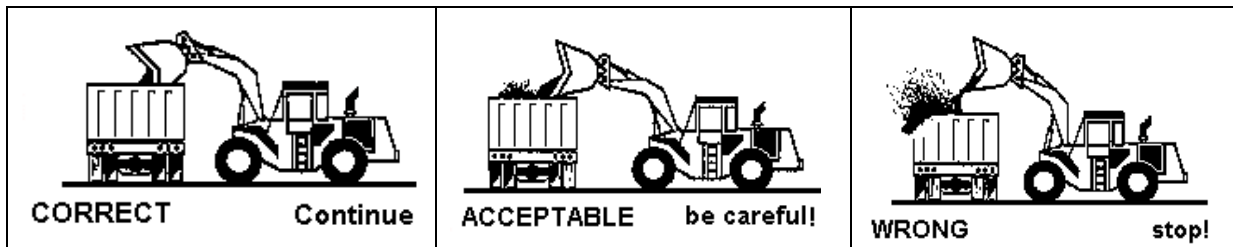
Figura 29– Esempio di corretto svolgimento delle attività di carico con pala meccanica.
