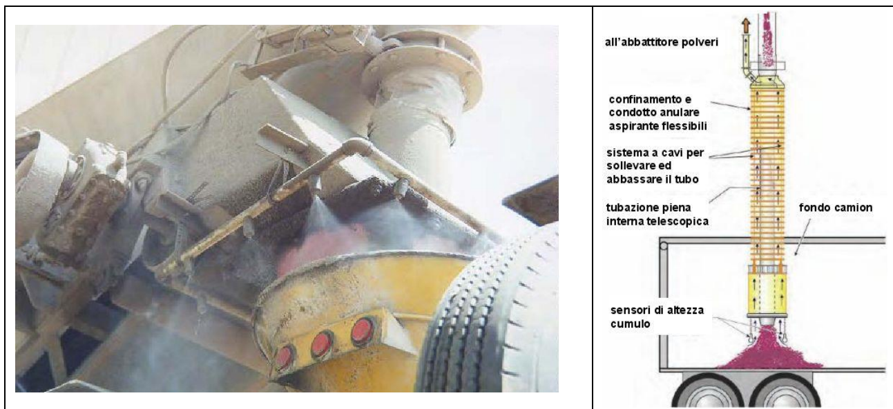
Figura 43 – Esempi: collettore ad ugelli spray applicato al punto di carico di una betoniera, tubazione di carico telescopizzata con sistema di aspirazione localizzata e sensore di prossimità.
