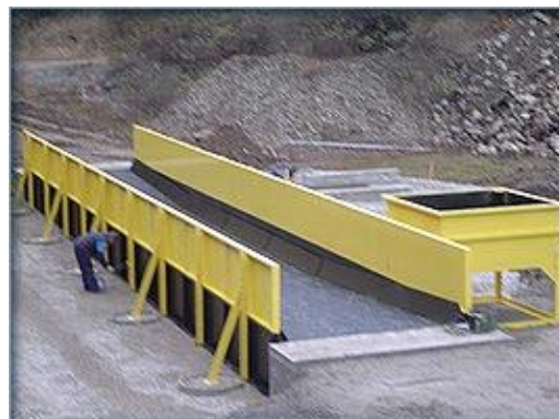
Figura 38 – sistemi di lavaggio dei pneumatici A BACINO.
