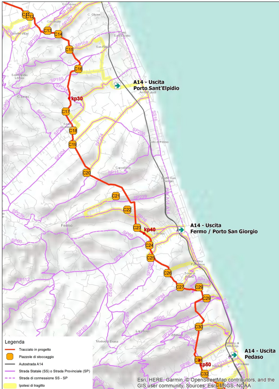
Fig. 4/B: sovrapposizione del tracciato in progetto con la viabilità della Regione Marche. Tavola 2/3, piazzole C11 - C33.
