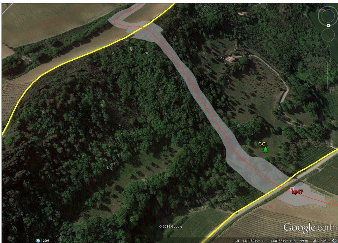
Fig. 3.6 – panoramica del versante individuato per l'analisi sito-specifica. In rosso il tracciato del metanodotto in progetto, in grigio l'ingombro della pista di lavoro.
