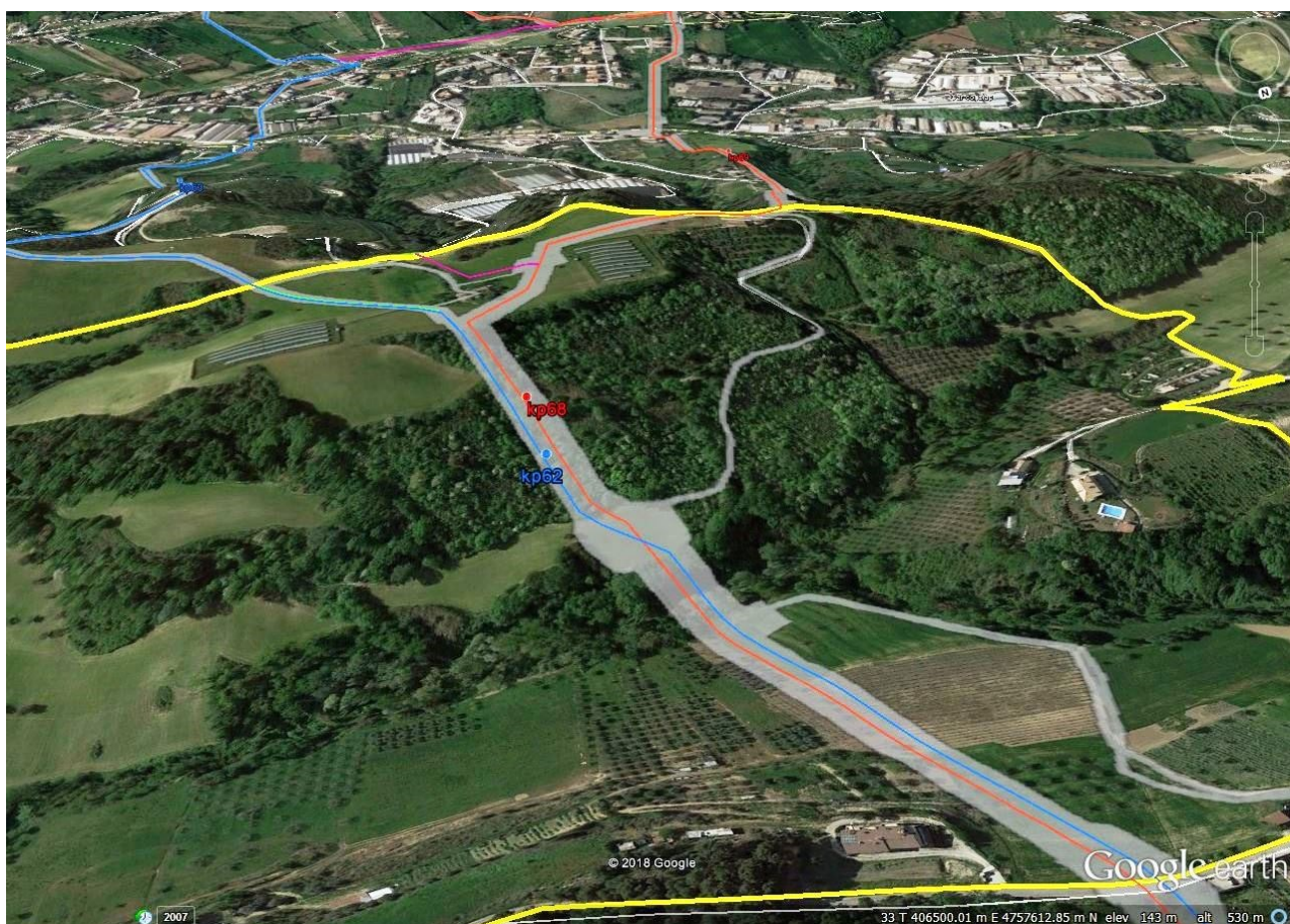
Fig. 7.6 - panoramica dei versanti interessati dalla linea in progetto all'interno della patch selezionata per l'analisi sito-specifica. In rosso il tracciato del metanodotto in progetto, in blu la linea esistente ed in grigio l'ingombro della pista di lavoro.
