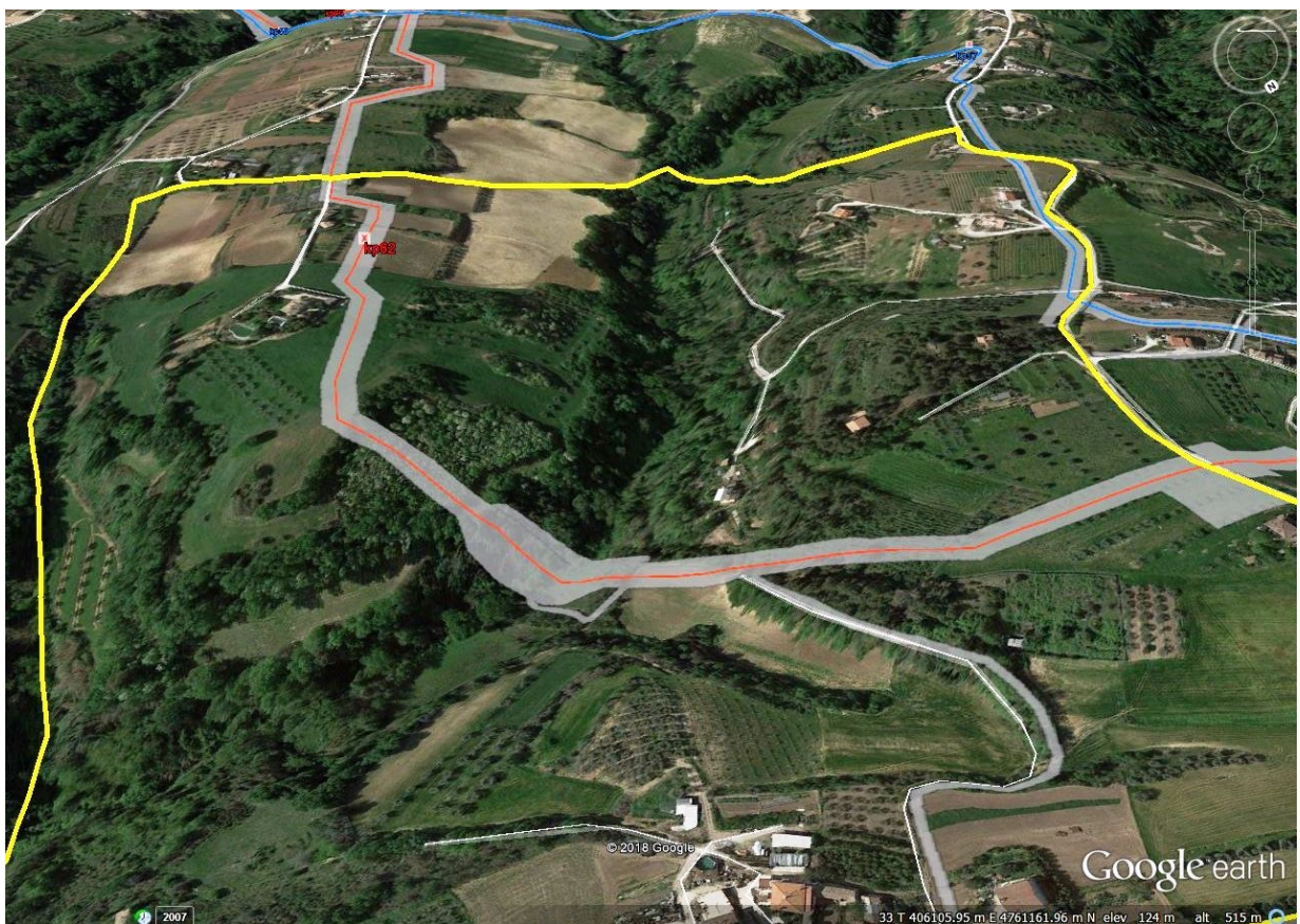
Fig. 6.6 - panoramica dei versanti interessati dalla linea in progetto all'interno dell'area selezionata per l'analisi sito-specifica. In rosso il tracciato del metanodotto in progetto, in grigio l'ingombro della pista di lavoro, in blu il tratto di dismissione.
