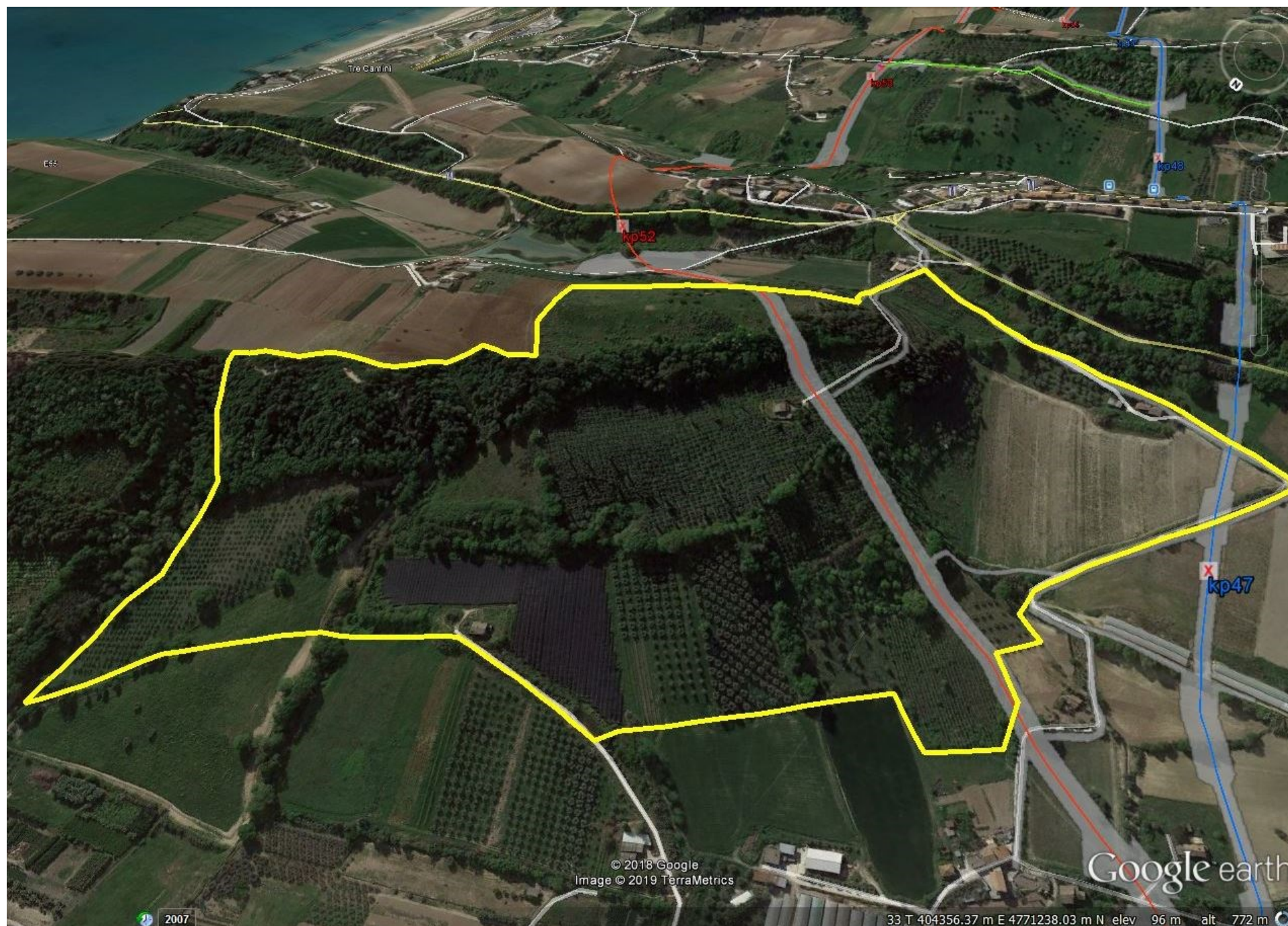
Fig. 4.1 – Panoramica dell'area di indagine "Monte Serrone" in Comune di Campofilone. In rosso la linea in progetto, in blu quella in dismissione, in grigio le aree di cantiere.
