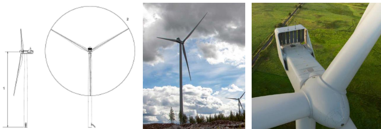
Figura 36: Elementi dimensionali e compositivi significativi degli aerogeneratori Vestas V150 (Fonte: Vestas)
