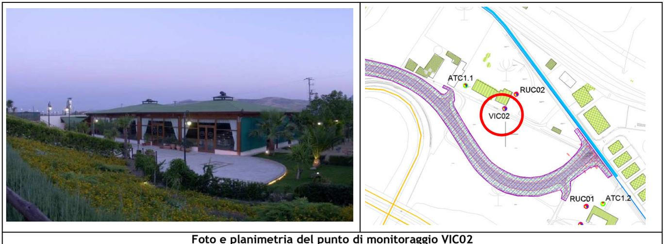
Il monitoraggio vibrazionale nel punto VIC02 è stato eseguito con una terna accelerometrica posizionata al piano terra di un edificio adibito a ristorante e, più precisamente, nella sala principale chiusa al pubblico durante le misure effettuate. Le sorgenti di vibrazione sono quelle indotte dal traffico veicolare presente sulla rampa di uscita Catenanuova e lungo l'autostrada A19 posta a circa 100 m di distanza.
