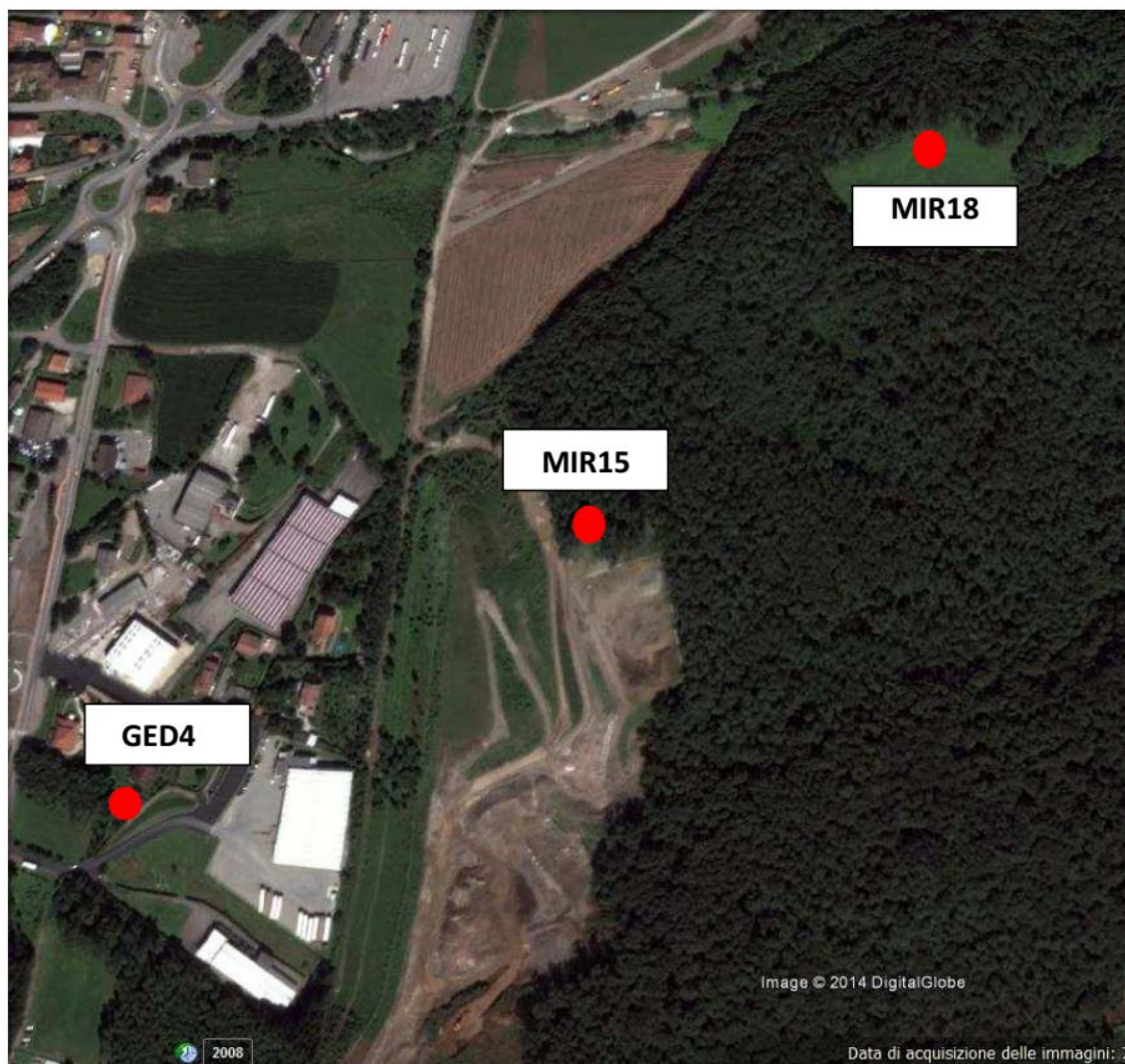
Fig. 35: Posizione dei piezometri utilizzati per le misure della quota della falda. Fonte: studio geologico geol. Paolo Oppizzi (2016).
