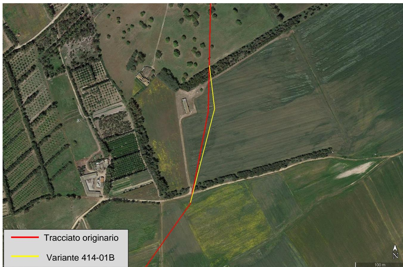
**Fig. 2.4/F: “Met. Derivazione per Villacidro DN 150 (6”)” - Variante 414-01B**
