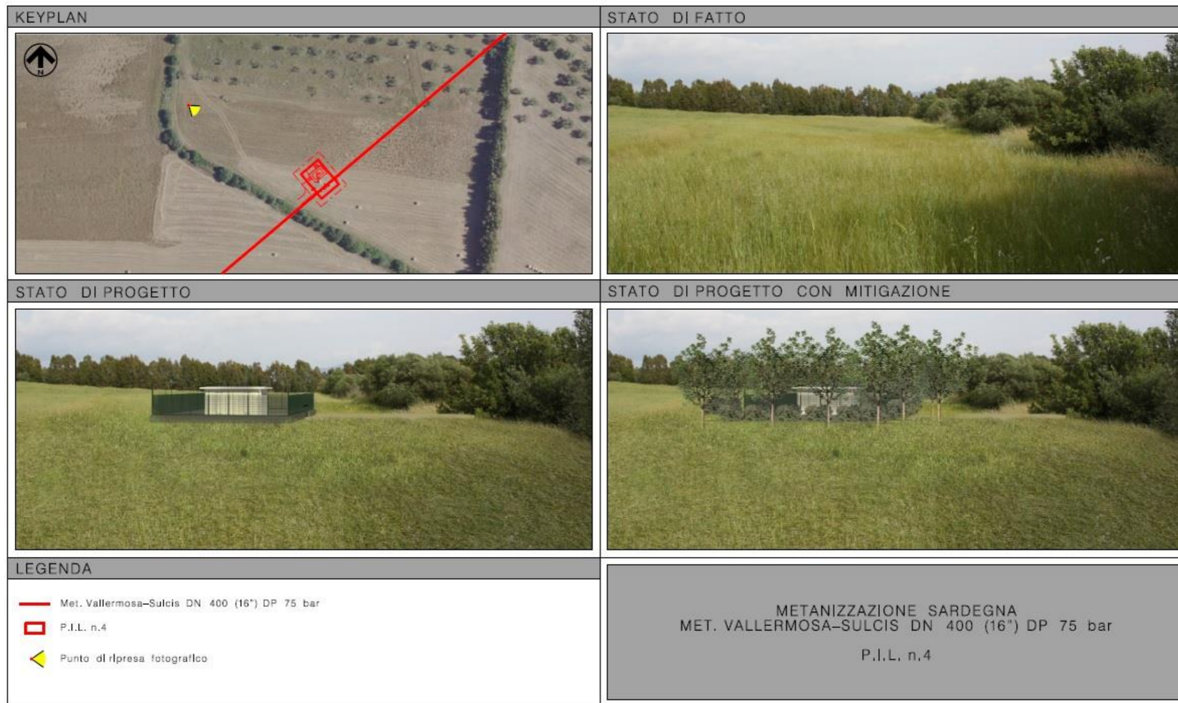
Fig. 3.1/S: Met. Vallermosa – Sulcis, simulazione fotografica della realizzazione del PIL n.4 e degli interventi di mitigazione dell'impatto visivo
