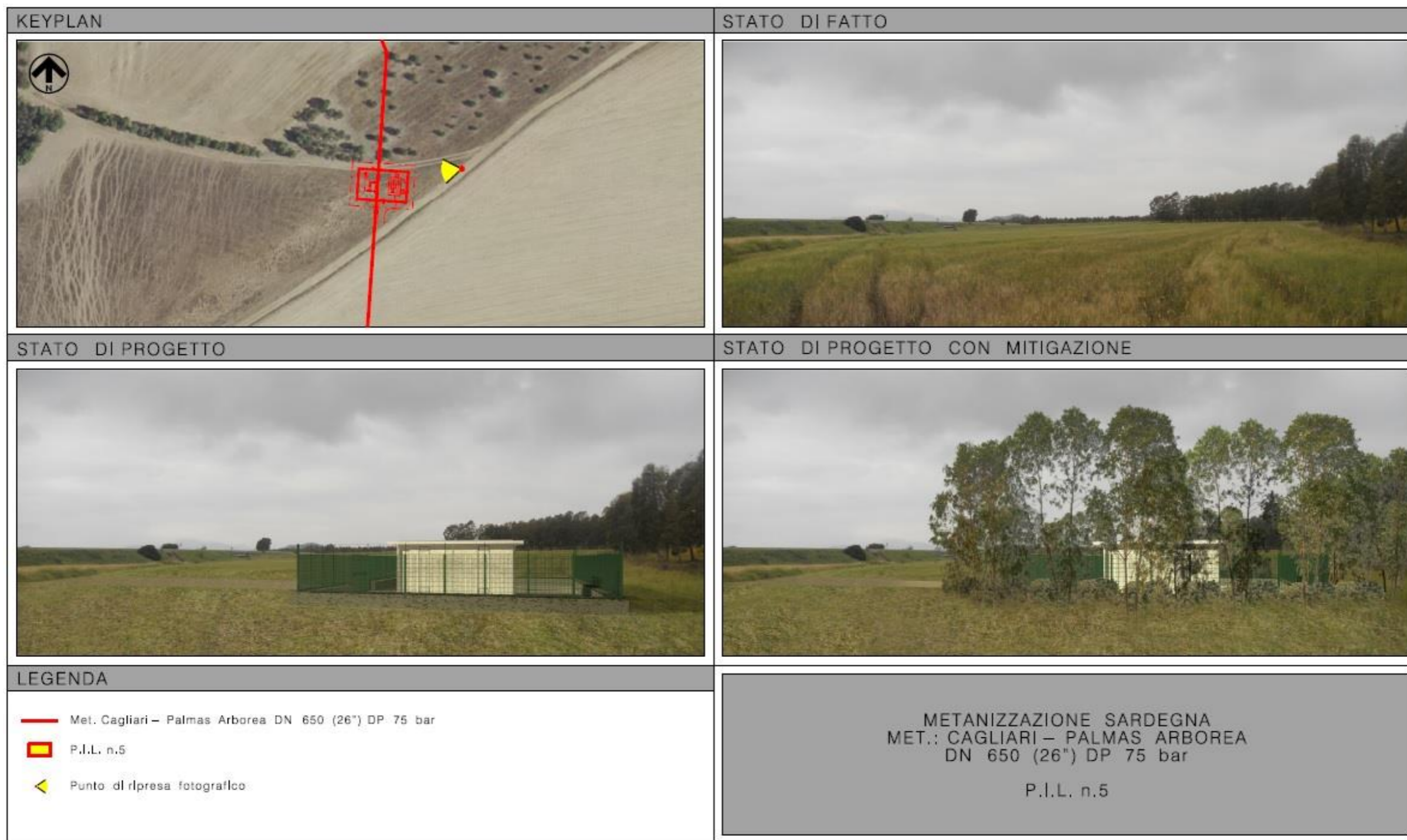
Fig. 3.1/G: Met. Cagliari – Palmas Arborea, simulazione fotografica della realizzazione del PIL n.5 e degli interventi di mitigazione dell'impatto visivo
