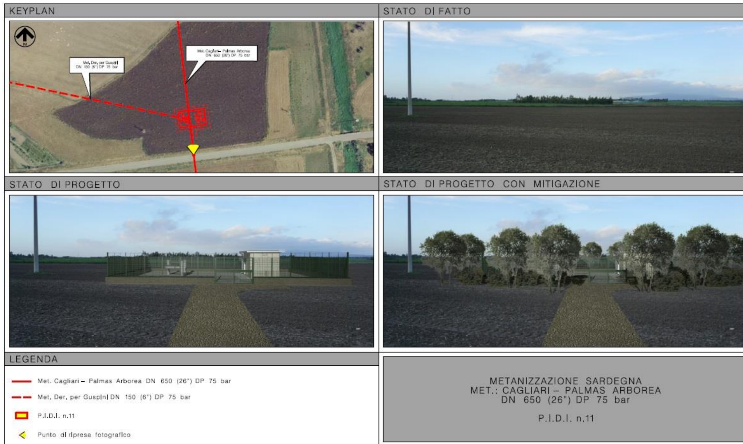
Fig. 3.1/M: Met. Cagliari – Palmas Arborea, simulazione fotografica della realizzazione del PIDI n.11 e degli interventi di mitigazione dell'impatto visivo
