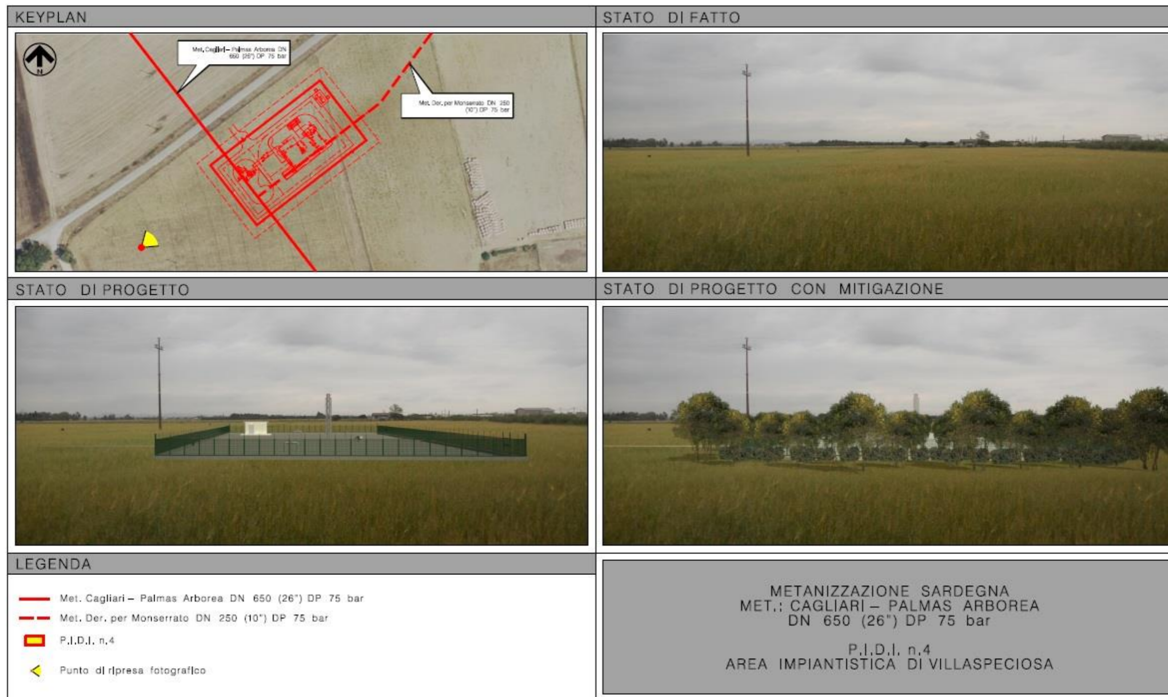
Fig. 3.1/F: Met. Cagliari – Palmas Arborea, simulazione fotografica della realizzazione del PIDI n.4 e degli interventi di mitigazione dell'impatto visivo
