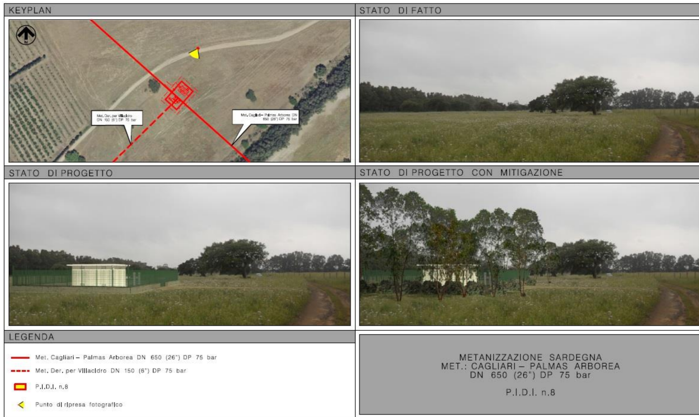
Fig. 3.1/J: Met. Cagliari – Palmas Arborea, simulazione fotografica della realizzazione del PIDI n.8 e degli interventi di mitigazione dell’impatto visivo
