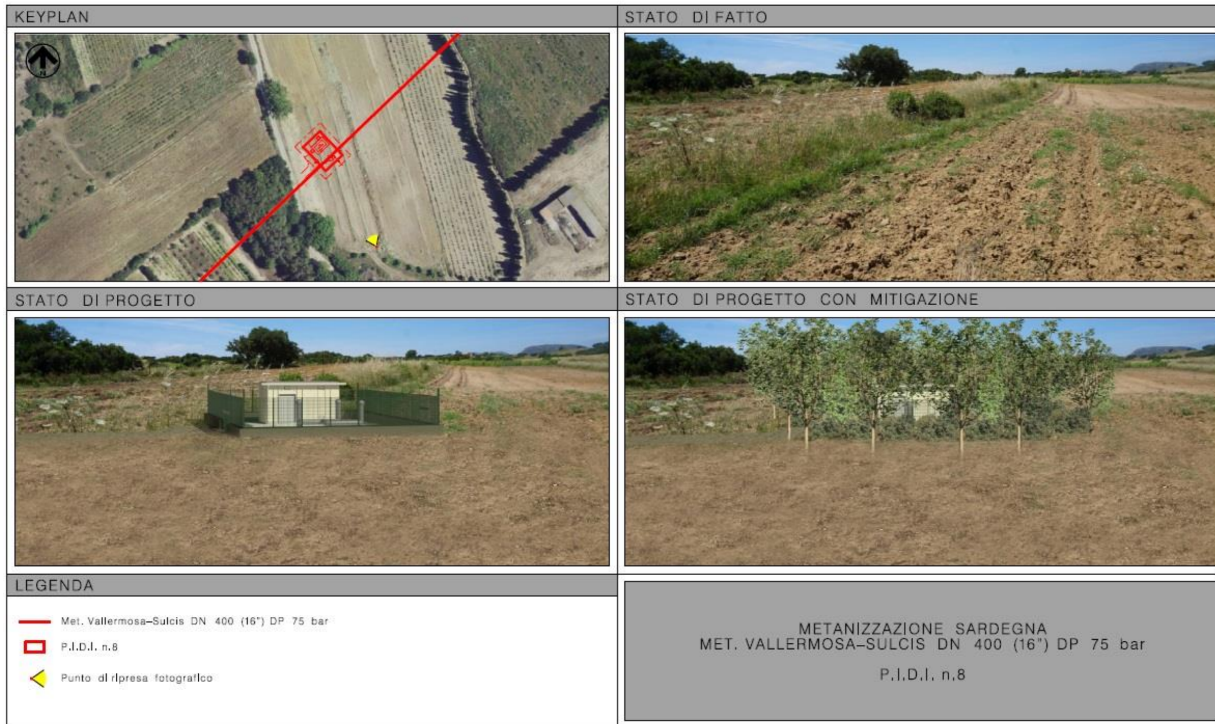
Fig. 3.1/W: Met. Vallermosa – Sulcis, simulazione fotografica della realizzazione del PIDI n.8 e degli interventi di mitigazione dell'impatto visivo
