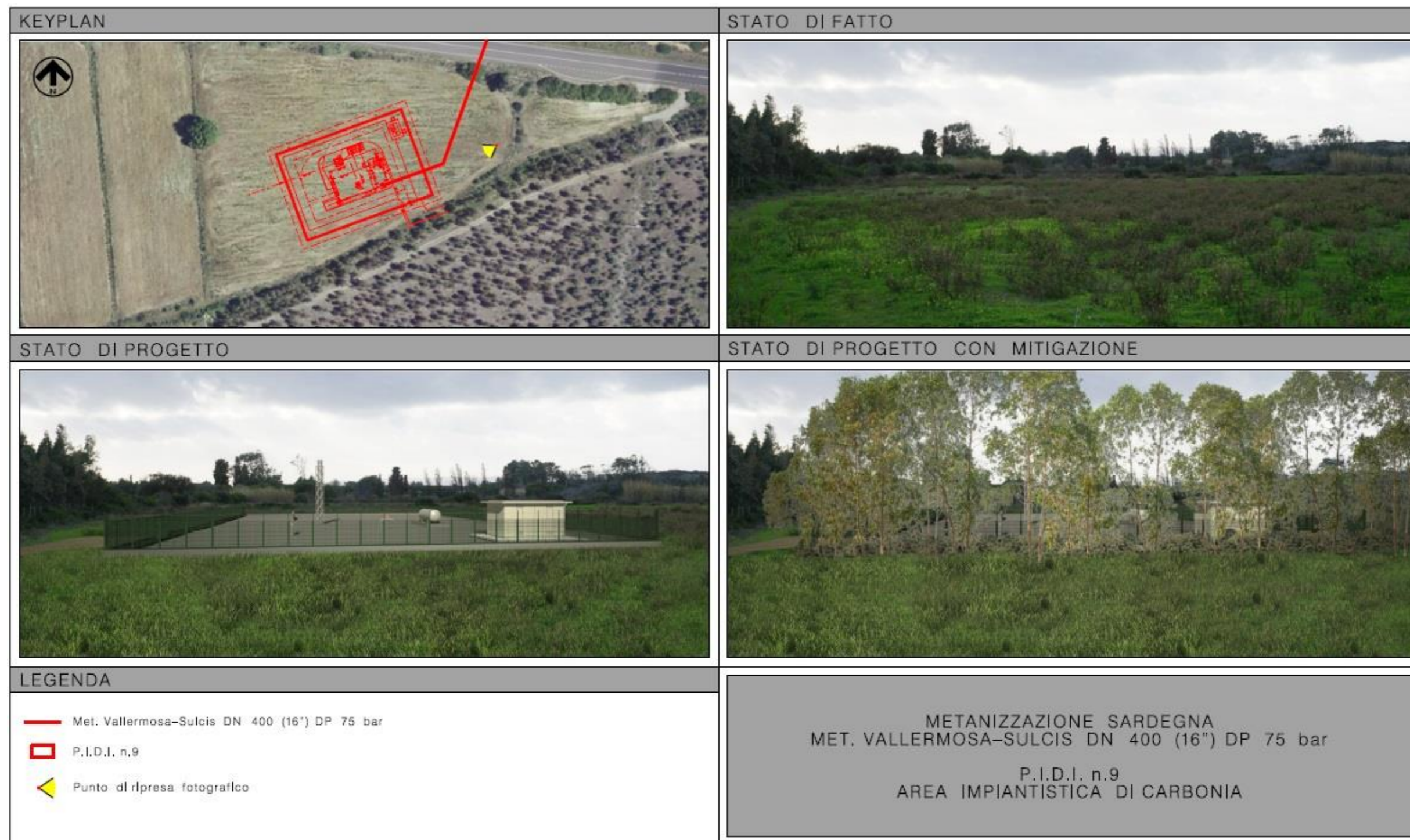
Fig. 3.1/X: Met. Vallermosa – Sulcis, simulazione fotografica della realizzazione del PIDI n.9 e degli interventi di mitigazione dell’impatto visivo
