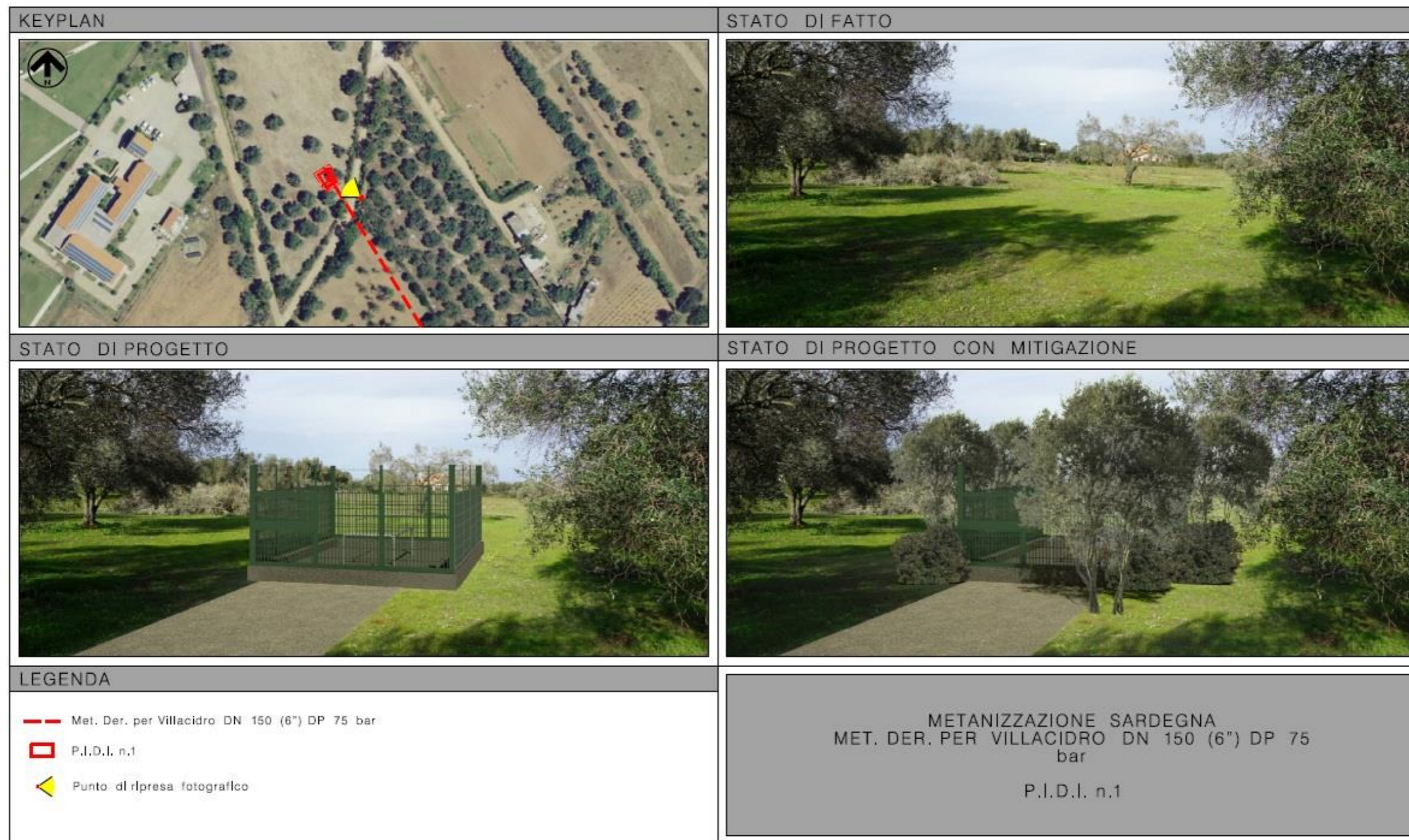
Fig. 4.3/A: Met. Derivazione per Villacidro, simulazione fotografica della realizzazione del PIDI n.1 e degli interventi di mitigazione dell'impatto visivo
