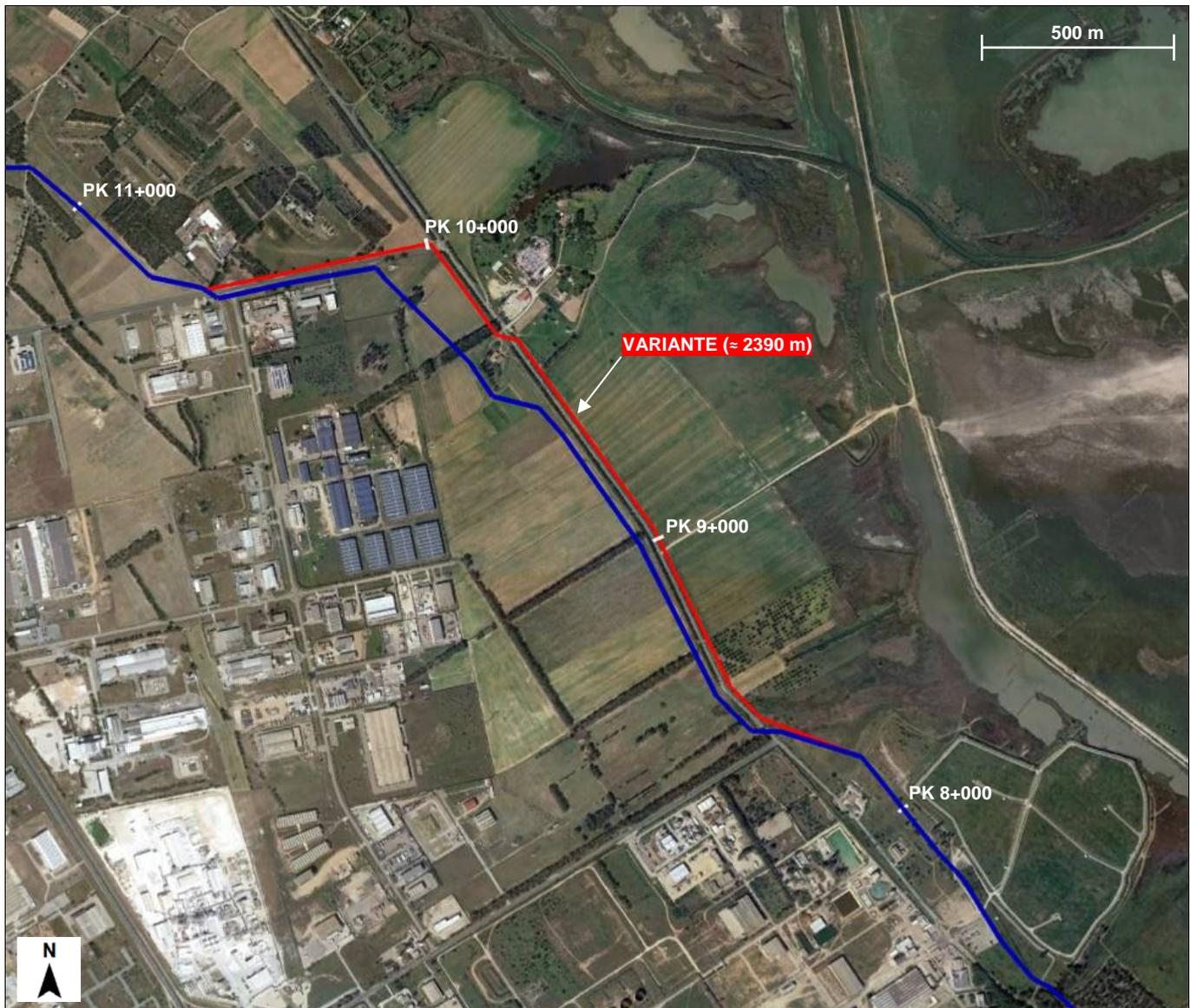
Figura 1-2: Tratto di tracciato Cagliari-Palmas Arborea DN650 interferente con l'area SIN di Macchiareddu | Zoom della variante.
